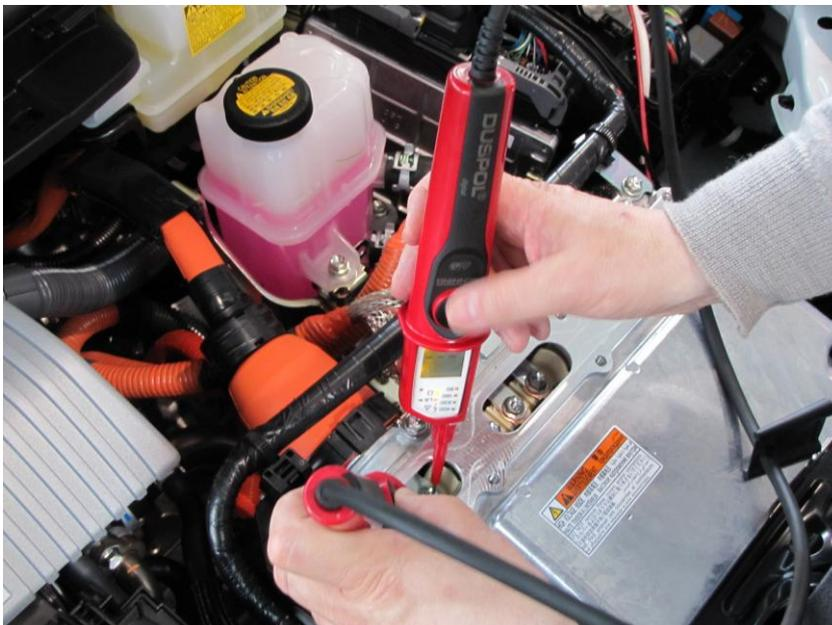
Danach wird die Spannungsfreiheit mit einem zweipoligen Spannungsprüfer am Eingang des Inverters festgestellt. Als Funktionskontrolle des Spannungsmessgerätes wird kurz vorher, z.B. an einer Steckdose, gemessen. Im aktiven Hochvoltssystem nimmt diese von der HV-Batterie kommende Leitung je nach derzeitigen Fahrzeugtypen Spannungen von 140 V DC bis zu 800 V DC im Pkw-Bereich und im Nutzfahrzeugsbereich bis zu 900 V DC an.
