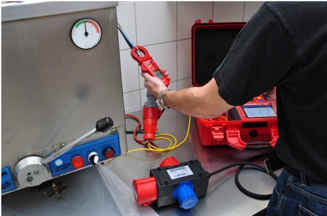
Dreiphasige Verbraucher können schnell und zuverlässig mit Hilfe der BENNING Messadapter 044127 und 044128 geprüft werden. Dabei wird mit der Leckstromzange BENNING CM 9 entweder der Differenzstrom über alle aktiven Leiter (L1, L2, L3 + N) gemessen oder der Ableitstrom über den Schutzleiter (PE). Die abgelesenen Messwerte können am Gerätetester BENNING ST 750 A direkt eingegeben werden, was die Prüfung erheblich vereinfacht. Ein passender Prüfablauf ist im Gerätetester bereits hinterlegt.
