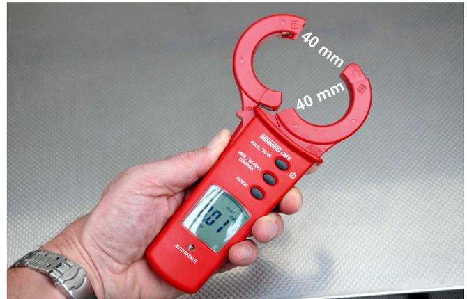
Großzügige 40 mm für Zangenöffnung und Zangendurchmesser erlauben es, mit der BENNING CM 9 auch dickere Kabel oder starke Leitungsbündel problemlos zu umfassen.
