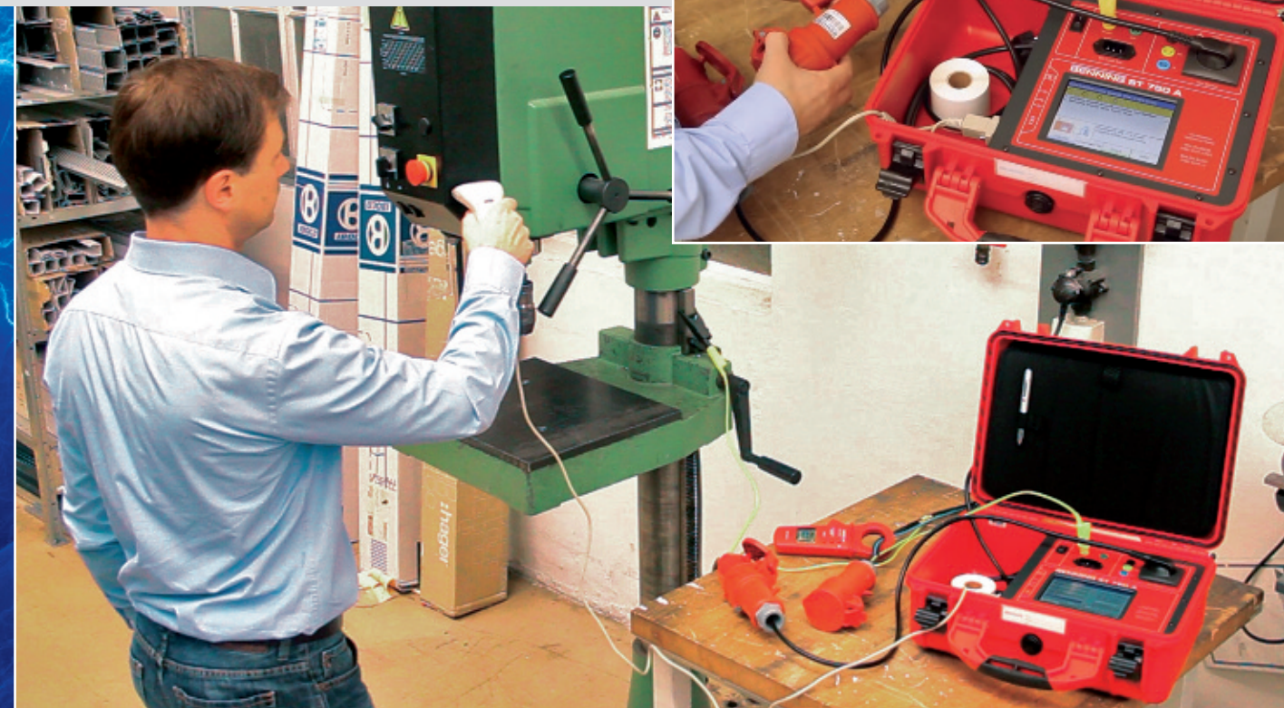
Mit Hilfe des Barcodescanners wird der einmal erfasste Prüfling z. B. bei Wiederholungsprüfungen automatisch erkannt. Selbst die Gefährdungsbeurteilung bleibt stets mit dem Prüfling verknüpft. Eine Differenzstrommessung kann bei 3-phasigen Verbrauchern via Leckstromzange BENNING CM 9 und Prüfadapter erfolgen.
