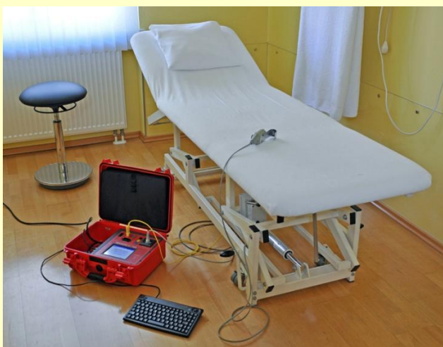
Prüfungen nach DIN VDE 0751-1 an einer elektromotorisch einstellbaren Behandlungsliege mit dem BENNING ST 750 A.
