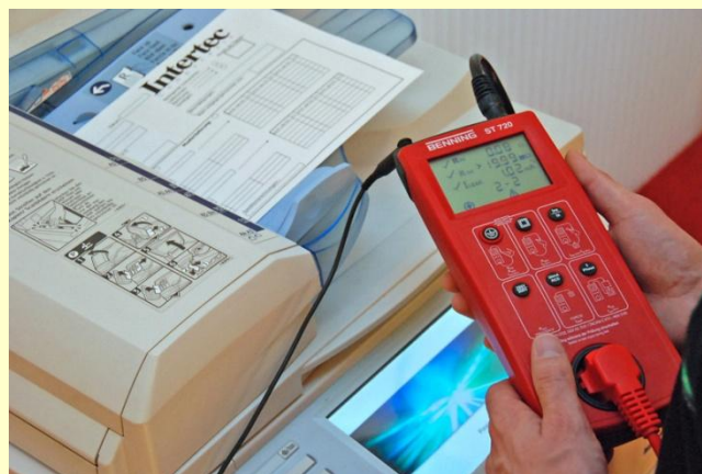
Sicherheitsprüfgerät Benning ST 720. Test eines Abteilungsdruckers unter Funktionsbedingungen nach Instandsetzung.
