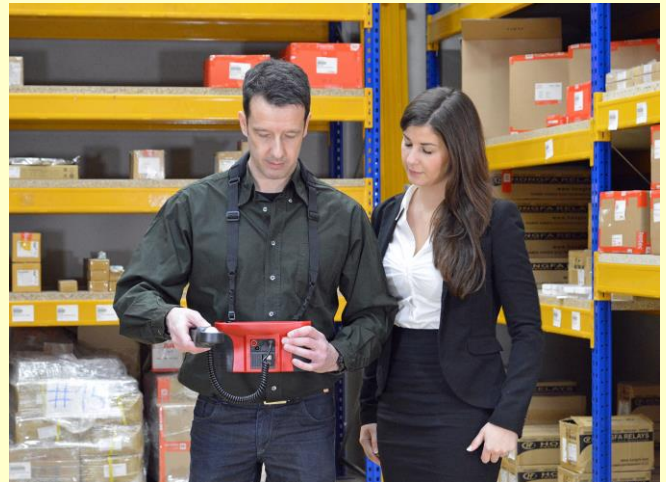
Messung der Beleuchtungsstärke in einem Lager
