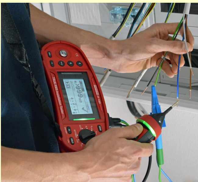
Isolationsmessung mit Commander-Prüfspitze
