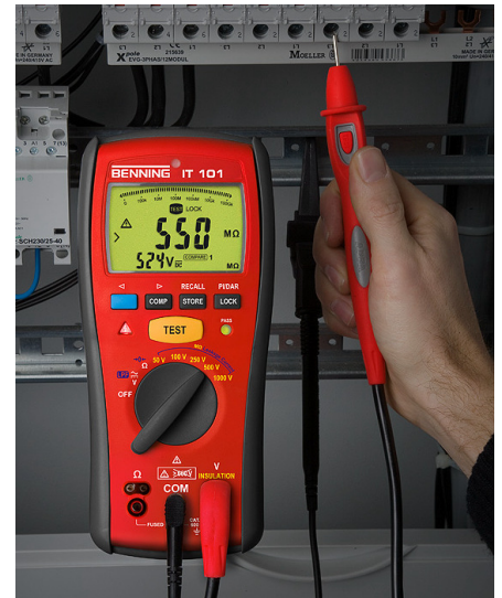
Bild 2: Isolationswiderstandsmessung an elektrischer Anlage
