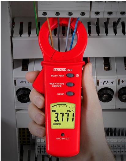
Bild 3: Differenzstrommessung am FI/RCD-Schutzschalter
