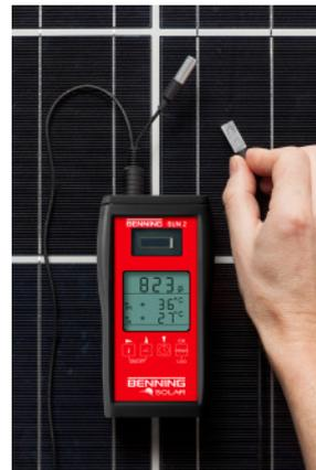
Messergebnisse von PV-Anlagen können nur objektiv verglichen werden, wenn die Umgebungsbedingungen z. Z. der Messung konstant sind. Um dieses nachzuweisen ist das Einstrahlungs- und Temperaturmessgerät BENNING SUN 2 eine passende Ergänzung. Das BENNING SUN 2 erfasst die solare Einstrahlung ( $W/m^2$ ) über eine Referenzzelle sowie die Modul- und Umgebungstemperatur über den 2-Kanal-Tempersensor.
