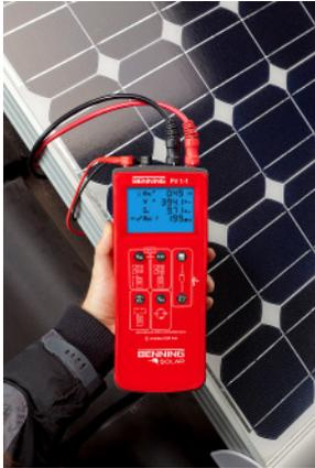
Photovoltaiksysteme sind heute ein gewohntes Bild auf Dächern und Freiflächen. Nur fachgerecht installierte PV-Anlagen erzielen die prognostizierten Erträge und entsprechen den aktuellen Sicherheitsvorschriften. Zahlreiche Standards, Richtlinien und Vorgaben für die Installation müssen beachtet werden. Dazu gehört die Dokumentation der PV-Anlage mit Inbetriebnahmeprüfung gemäß DIN VDE 0100-600 und VDE 0123-23 (DIN EN
