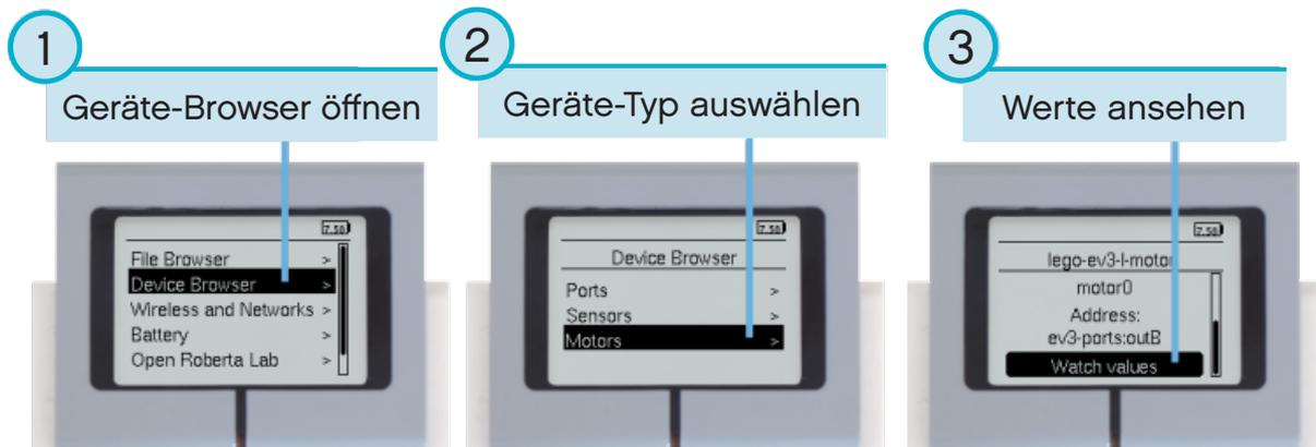
Abbildung 1.6: Anzeigen der Motor- und Sensorwerte
