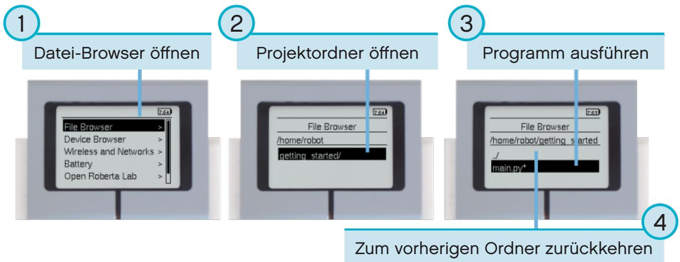
Abbildung 2.9: Ausführen eines Programms über die Tasten auf dem EV3 Stein
