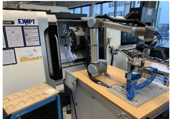
Abbildung 8: Flexible und temporäre Automatisierung von Werkzeugmaschinen. Foto: WZL der RWTH Aachen
