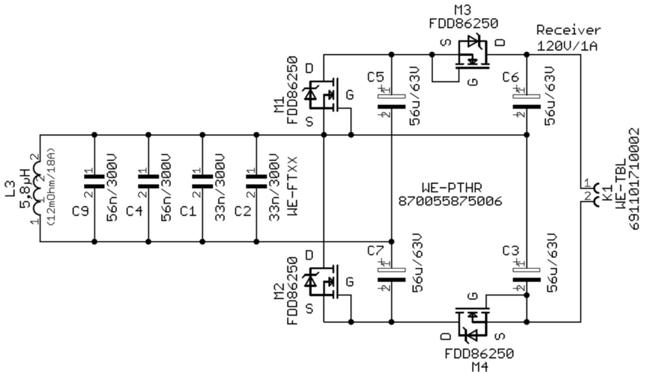
Abbildung 15: Brückengleichrichterschaltung mit MOSFET Body Dioden und Ripplestromfeste Aluminium Polymer SMD Kondensatoren und einer vierfachen Spannungserhöhung; Alternativ können auch 150V/3A Schottky Dioden verwendet werden.
