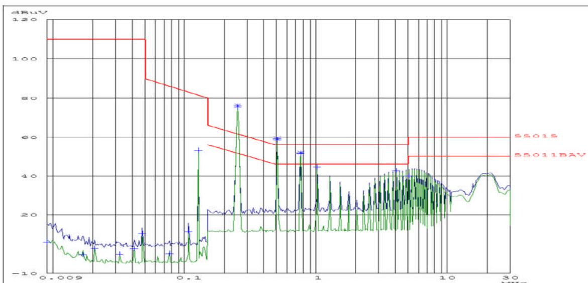
Abbildung 10: Beispiel für ein Spektrum in der Störspannungsmessung (9 kHz-30 MHz / Limit Class B)
