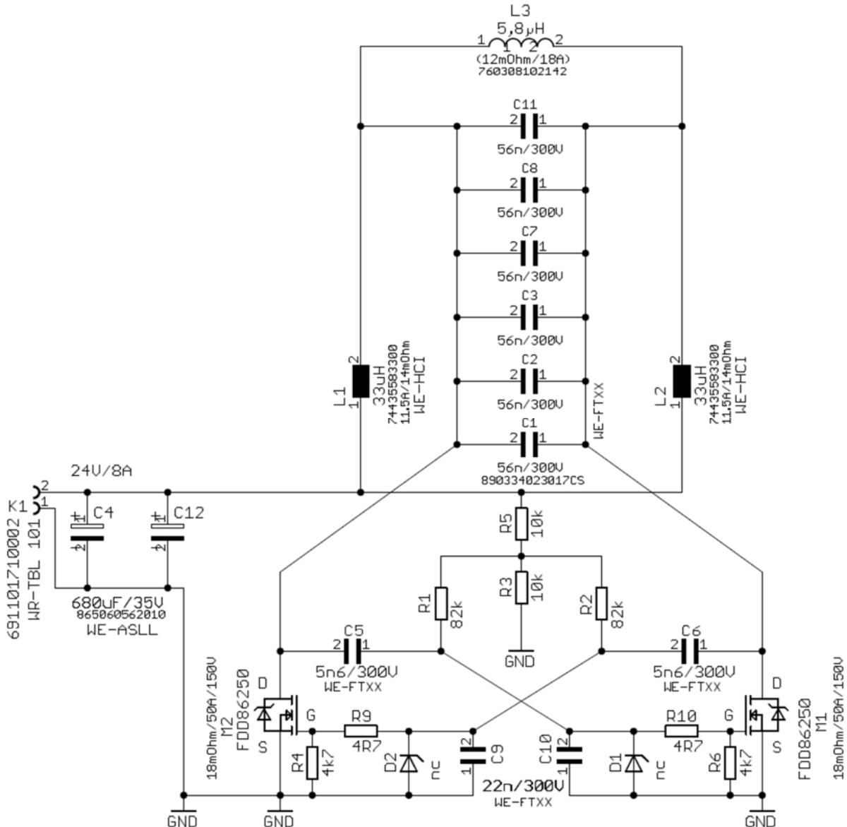
Abbildung 19: Sender für Versorgungsspannungen größer 20 VDC mit kapazitivem Gate Spannungsteiler. Alternativ kann aus der Versorgungsspannung mit Hilfe eines LDO oder DCDC Converter einer Hilfsspannung kleiner 20 VDC erzeugt werden. Die Vorspannung durch die Pull-Up Widerstände sollte bei diesem MOSFET min. 8 V sein. Statt R<sub>3</sub> kann auch eine Zenerdiode verwendet werden.
