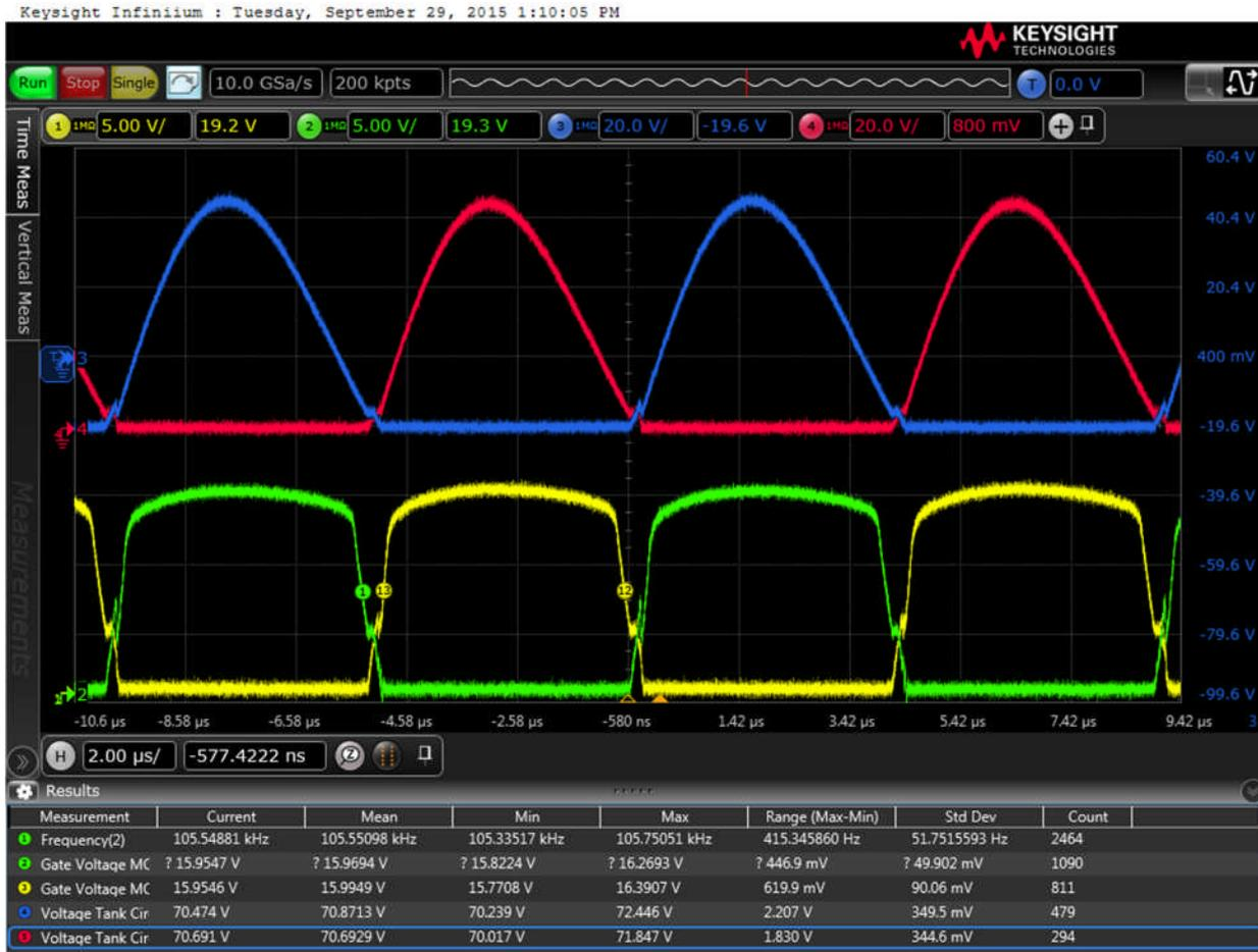
**Abbildung 3:** Blau und Rot sind die Spannungen an der Sendespule. Gelb und grün sind die Gate Spannungen (Diese gemessenen Spannungskurven sind referenziert gegen Schaltungs-GND;  $V_{in} = 20$  V;  $P_{out} = 100$  W; optimierte Gate Ansteuerung, siehe Applikationsbeispiele)
