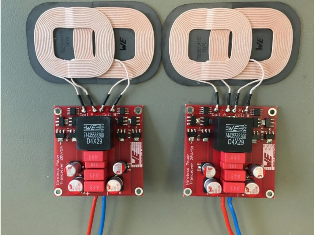
Abbildung 23: Aufbau Applikationsbeispiel Sender/Empfänger 3.9 für Spulenarray (760308104119)
