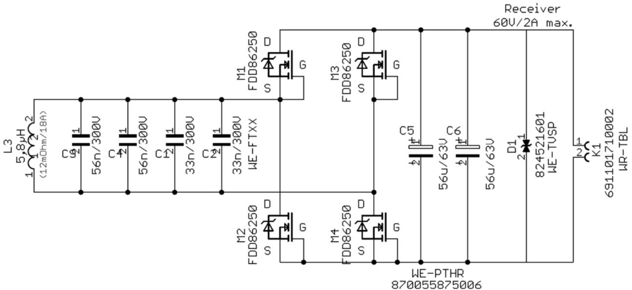
Abbildung 14: Brückengleichrichterschaltung mit MOSFET Body Dioden und Ripplestromfeste Aluminium Polymer SMD Kondensatoren. Alternativ können z.B. auch Schottky Dioden oder ein fertiger Brückengleichrichter verwendet werden.
