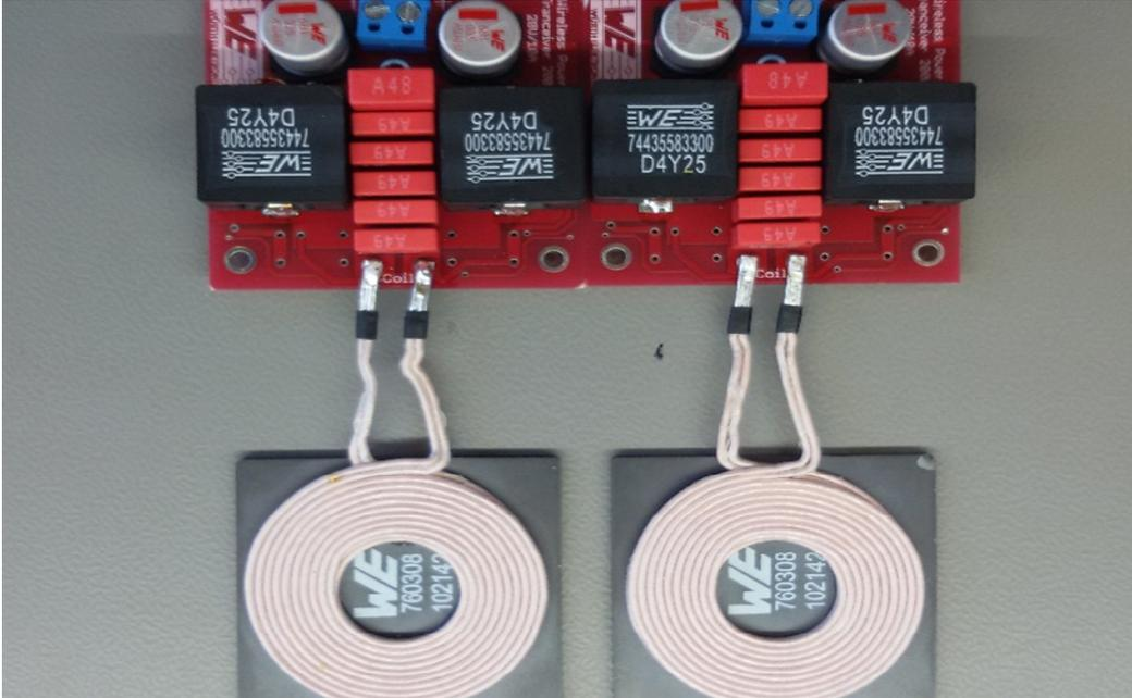
Abbildung 7: Vermessene Schaltung ( $V_{in} = 20 \text{ VDC}$ ;  $P_{out} = 100 \text{ W}$ ) bei 6,5 mm Luftspalt
