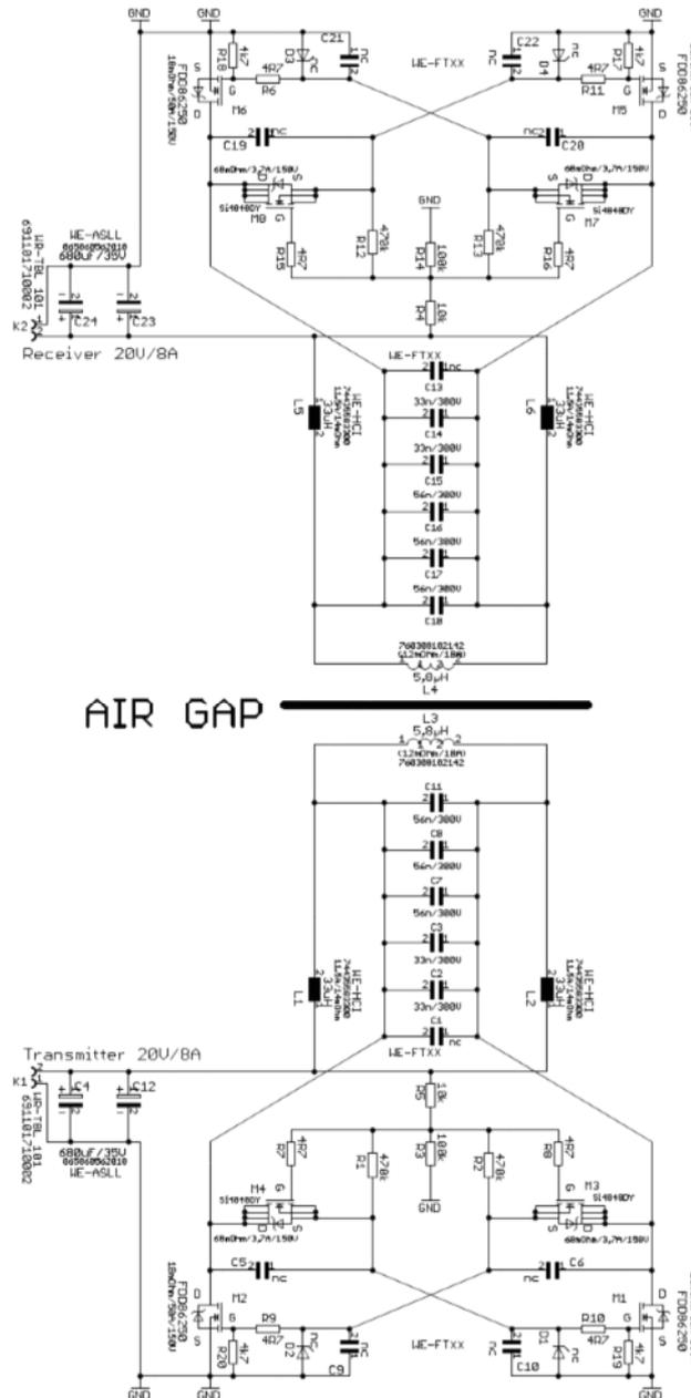
Abbildung 21: Bestückungsvarianten: Effektive Gate Ansteuerung über kleinere MOSFET's oder kapazitive Spannungsteiler ( $V_{cc}$  größer 20 V); **Diese Schaltung und Bestückung wurde für die Messungen innerhalb der AppNote verwendet!**
