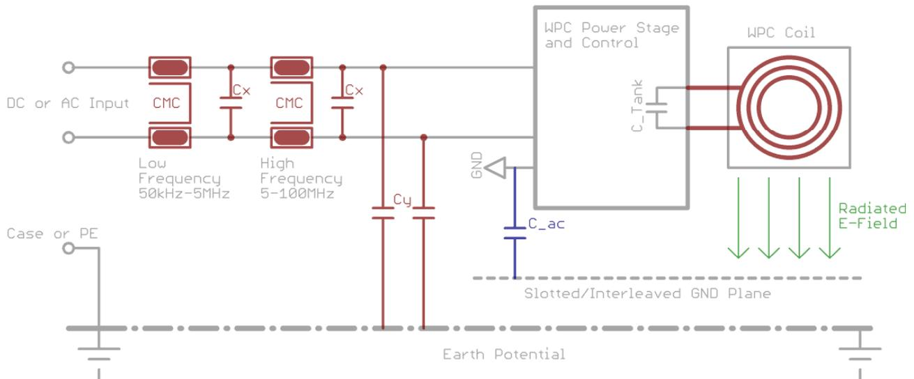
Abbildung 11: Maßnahmen zur Eindämmung von Common Mode und Differential Mode Störern
