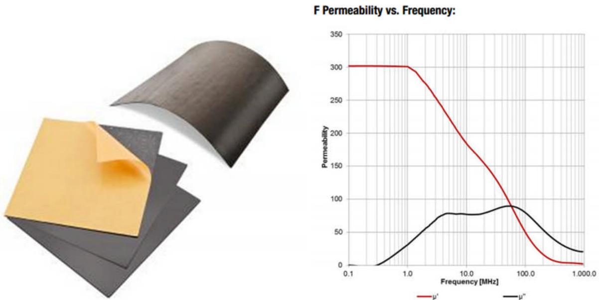
Abbildung 13: WE-FSFS Art.Nr. 374 006 ( $\mu'$  ist Realanteil und  $\mu''$  ist Imaginäranteil / Verluste)
