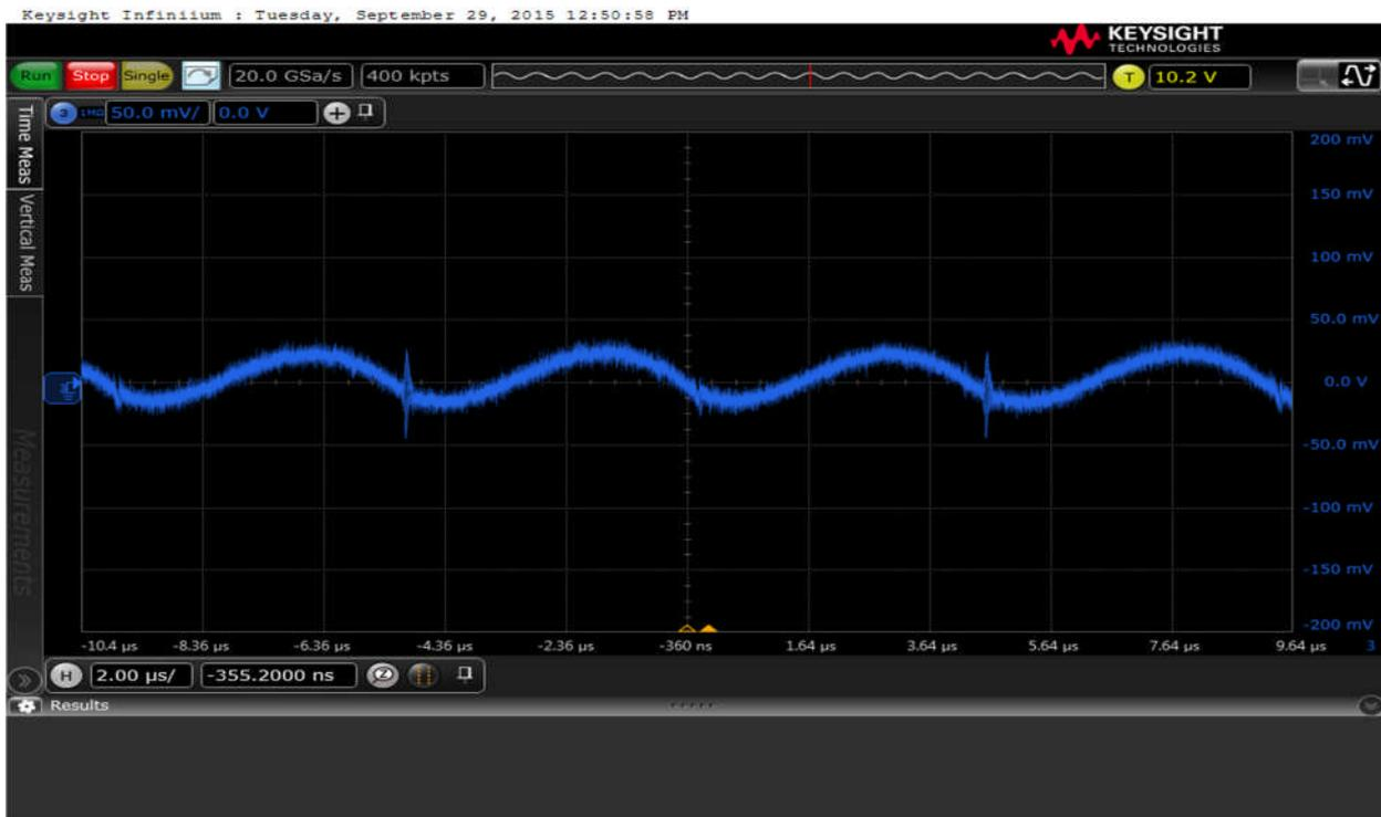
Abbildung 5: Reflektierter Spannungsrippel und Rauschen zur Versorgung am Eingang der Senderseite ( $V_{in} = 20\text{ V}$  /  $P_{out} = 100\text{ W}$ )  $\rightarrow$  Verbesserung des Spannungsrippel durch zusätzlichen Einsatz von Polymer- & Keramik Kondensatoren mit niedrigem ESR.
