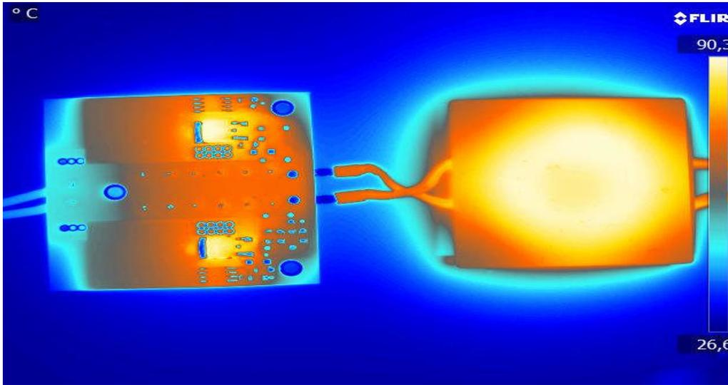
Abbildung 9: Erwärmung (Unterseite = MOSFETS + Gate Ansteuerung) der Schaltung / Spulen bei  $P_{out} = 100\text{ W}$  ( $V_{in} = 20\text{ V}$ )
