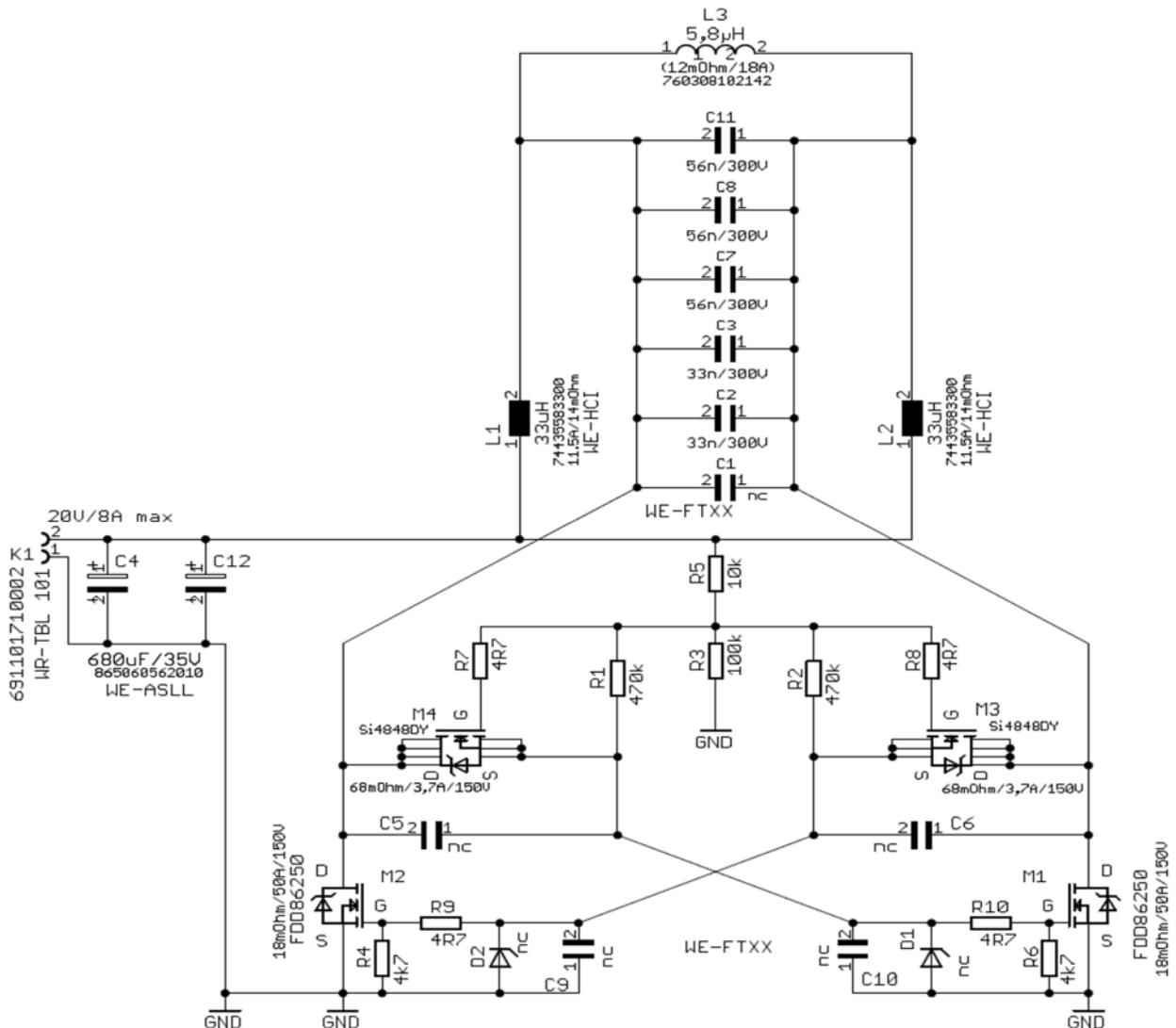
Abbildung 20: Bestückungsvarianten: Effektive Gate Ansteuerung über kleinere MOSFETs oder kapazitiver Spannungsteiler C5, C6, C9, C10 ( $V_{cc}$  größer 20V); die schnellere Gate Ansteuerung kann sich jedoch in der EMV negativ auswirken.
