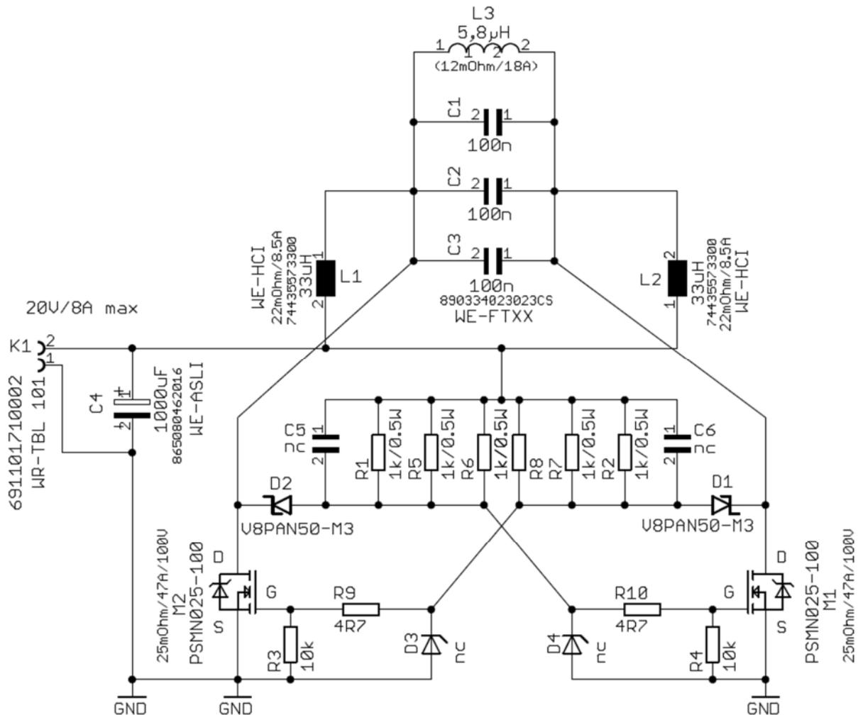
Abbildung 16: Beispiel für einfache und robuste Resonanzwandler Schaltung. Diese kann auf der Sender- als auch auf der Empfängerseite verwendet werden. Wenn man für die Pull-Up-Widerstände eine niedrigere Hilfsspannung generiert, kann die Verlustleistung gesenkt werden und die Oszillation mit dieser Hilfsspannung gestartet werden. C5 und C6 können 1nF/50V NP0 Kondensatoren sein (niedrige Impedanz für schnelle Flanke)
