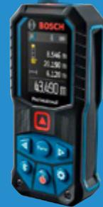
**Technische Daten:** Messzeit max.: 4 s · Messeinheit: mm · cm · m · ft · in · Stromversorgung (Details): 2 x AA Batterien · Gewicht: 0,580 kg · Gewicht Hinweis: ohne Batterien · Schutzart: IP65 · Speicher: 30 · Laser-Klasse: 2 · Laser-Wellenlänge: 635 nm · Abm.: (L x B x H) 29 x 53 x 119 mm · Kalibriert: Werksstandard (ohne Zertifikat) · Ausführung (Bosch): Bosch-Professional (Blau)
