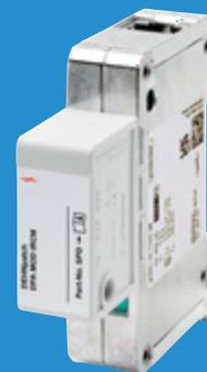
**Technische Daten:** Nennspannung: 3,3 V · Schutzart: IP20 · Normen: GHMT / IEC 61643-21 / EN 61643-21 · Abm.: (B x H x T) 19 x 75 x 51 mm.
