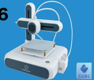
**Technische Daten:** Unterstütztes Druckmaterial: PLA · PCL · Druck-Breite (X) max.: 80 mm · Druck-Tiefe (Y) max.: 80 mm · Druck-Höhe (Z) max.: 80 mm · Extruder-Typ: Single · Geeignet für Filament-Ø: 1.75 mm · Düsen-Ø: 0.7 mm · Druckschicht Dicke (min.): 0.1 mm · Druckschicht Dicke (max.): 0.4 mm · Schnittstellen: USB-C® · Besonderheiten: inkl. Filament.
