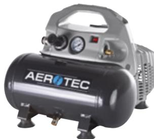
**Technische Daten:** Leistung: 370 W · Ansaugleistung: 70 l/min · Förderleistung: 55 l/min · Betriebs-Überdruck: 8 bar · Drehzahl (max.): 2750 U/min · Betriebsspannung: 230 V · Gewicht: 6 kg.
