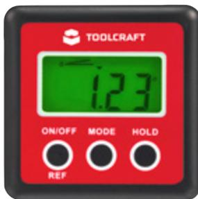
**Ausstattung:** Magnete auf der Unterseite des Winkelmessers für leichtes und festes fixieren an metallischen Oberflächen und Werkzeugen · Hohe Genauigkeit: ±0.1° · Großes LC-Display für einfaches Ablesen der Winkelmaße · 180° Winkelmessung · Automatische Abschaltung nach drei Minuten Ruhezustand · Spritzwassergeschützt IP54 · Kompaktes und robustes Design.
