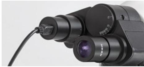
Okularkamera am Tubus befestigt
