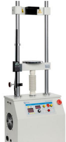
Motorisierter Prüfstand inkl. Längenmessgerät LB
