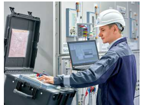
Die FAME-Prüfstecksysteme ermöglichen die einfache Prüfung auch außerhalb des Schaltschranks. Somit erledigen Sie die Prüfungen im Bereich der Netzschutztechnik sicher und im Handumdrehen.
