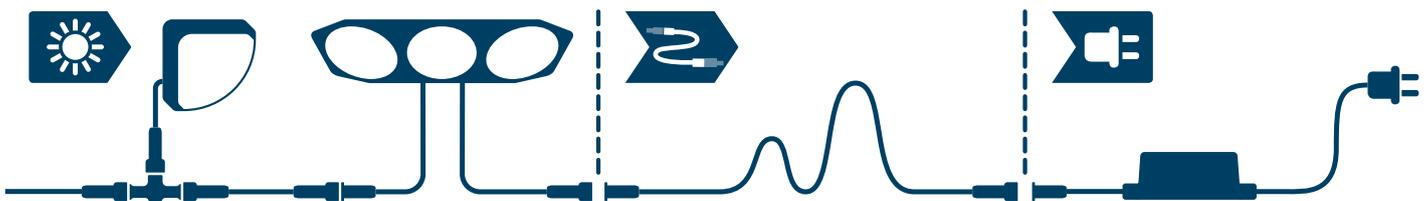
Alle Komponenten einfach von Leuchte zu Leuchte oder mit T-Verbinder weiterverbinden
