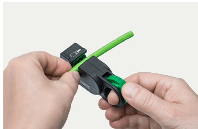
Leitungsende mit dem FastConnect Stripping Tool absetzen
