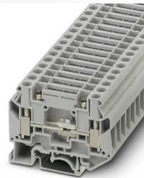
6 (10) mm 2 , 57 A, Trennklemme, mit Prüfbuchsen
