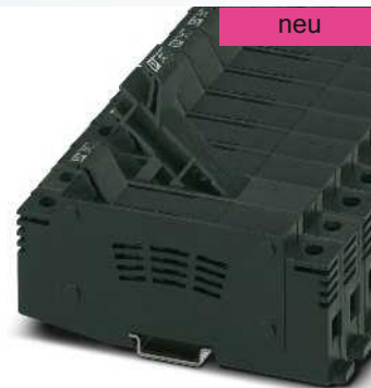
25 (25) mm 2 , 32 A, 1500 V, Hebelsicherungsklemme für Midget-Sicherungen 10,3 x 85 mm
