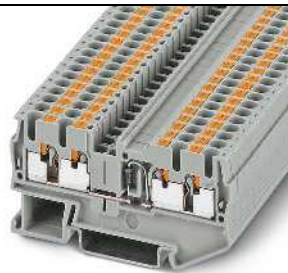
0,5 A, Diodenklemme, 1N 4007 (1300 V/0,5 A), 4 Anschlüsse
