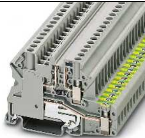
0,5 A, Diodenklemme, 1N 4007 (1300 V/0,5 A), Durchlassrichtung: von links nach rechts
