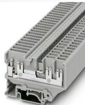
4 (4) mm 2 , 29 A, Durchgangsklemme, mit Schraub- und Flachsteckanschluss
