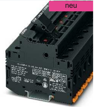
25 (25) mm 2 , 32 A, 1000 V, Hebelsicherungsklemme für Midget-Sicherungen 10,3 x 38 mm
