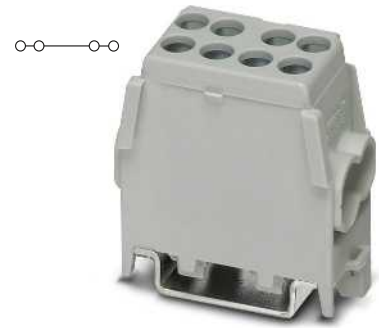
25 (25) mm 2 , 101 A, Hauptleitungs-Abzweiggklemme, 2 Abgänge 16 mm 2
