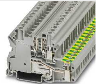
0,5 A, Diodenklemme, 1N 4007 (1300 V/0,5 A), Durchlassrichtung: von rechts nach links
