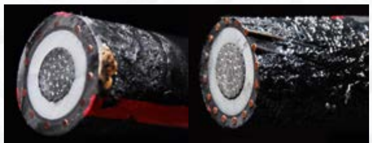
Kabel geschützt mit Scotch® 77 Brandschutzband nach dem Test
