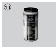
14 Kontroll- und Abgleichsalz für Hochfeuchte bei 94,5 %rF
