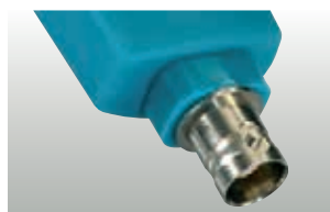
testo 206-pH3: pH3-Sondenkopf mit BNC-Schnittstelle
