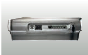
Seitlicher Anschluss von Mini-USB-Kabel und SD-Karte
