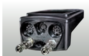
2 frei belegbare Fühlereingänge für Druck und Temperatur
