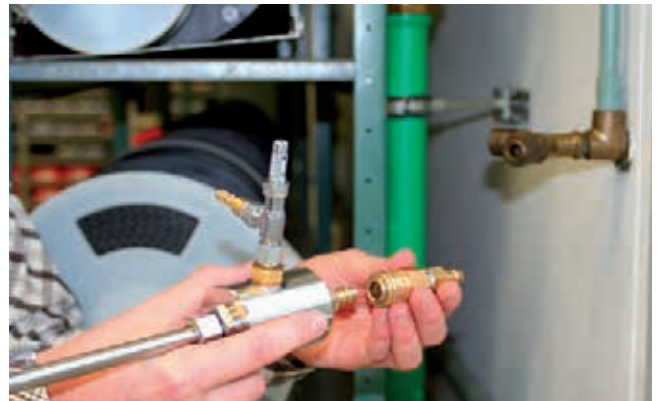
Anschluss des Restfeuchtefühlers testo 6615 über Messkammer und Vorfilter
