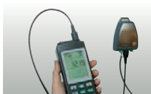
Überprüfung von Messwert-Umformern mit 4...20 mA-Interface
