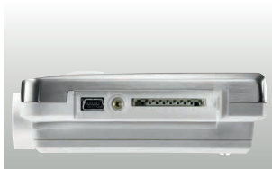
Seitlicher Anschluss von Mini-USB-Kabel und SD-Karte
