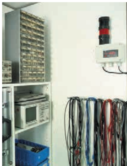
Die beiden Relaisausgänge des testo 54 ermöglichen dezentrale Alarmer bei Grenzwertüberschreitung, z.B. mit Hilfe der Alarmsäule.
