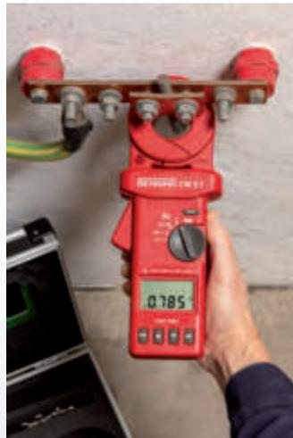
Messung des Erdschleifenwiderstandes eines Anlagenerders
