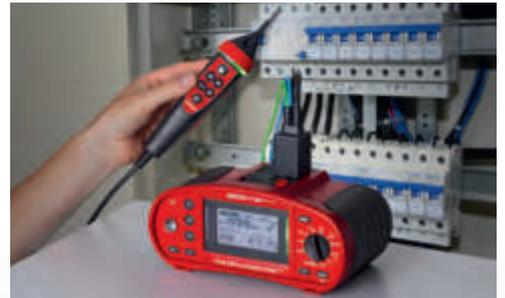
IT 115 bei der Schleifenimpedanzmessung ohne RCD-Auslösung
