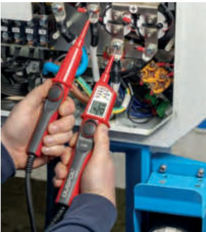
Prüfung der Ausgangsspannung einer DC-Ladeeinrichtung
