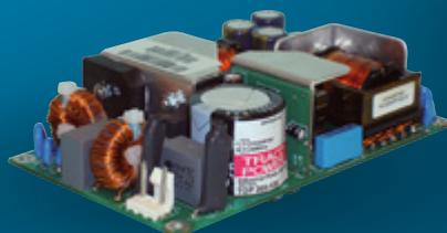
**Open Frame Schaltnetzteil**
