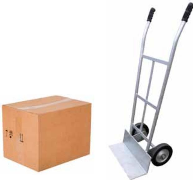
Einfache Maschinen bestehen nur aus sehr wenigen Teilen; zusammengesetzte Maschinen bestehen dagegen aus zwei oder mehr einfachen Maschinen. Eine Sackkarre ist ein Beispiel für eine zusammengesetzte Maschine. Sie kombiniert zwei einfache Maschinen. Die Griffe sind Hebel, die beim Heben der Last helfen, und das Rad und die Achse erleichtern das Bewegen der Last. Derselbe Grundsatz kommt auch bei einer Schubkarre zum Tragen.
