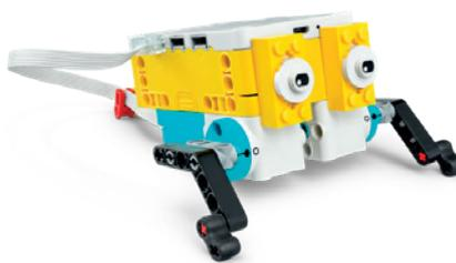
Mehrere Prototypen konstruieren und so die effektivste Möglichkeit finden, damit sich ein Roboter auch ohne Räder bewegt.
