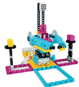
Einen automatisierten Helfer-Roboter bauen und programmieren, der Pakete an ihrer Farbe erkennt und versendet.
