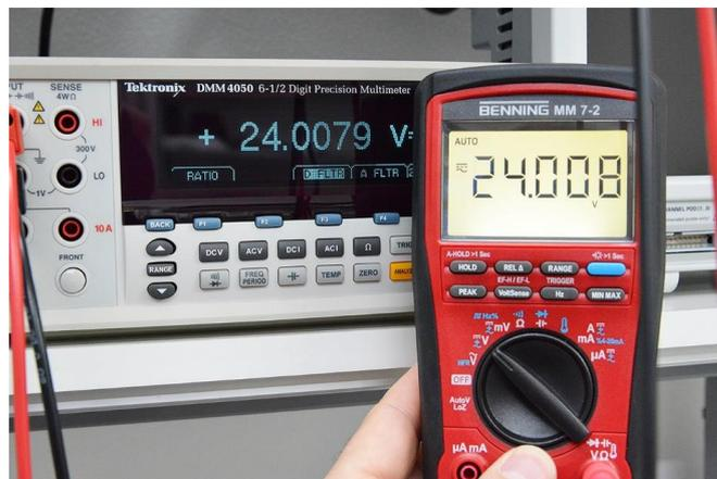
0,03 % DC-Grundgenauigkeit für präzise Messungen und anspruchsvolle Messaufgaben. (Vergleichsmessung im Labor mit einem kalibrierten Präzisions-Labormultimeter).
