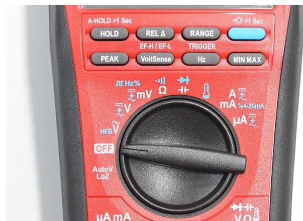
10-stufiger Drehschalter plus acht Funktionstasten
