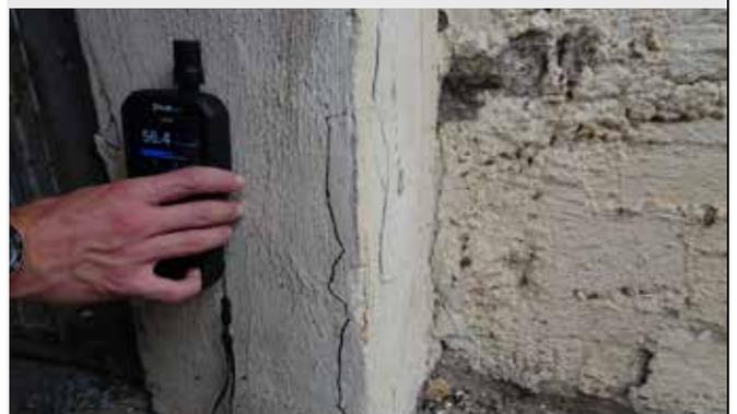
FLIR MR277 kombiniert Wärmebildgebung mit modernsten Umgebungssensoren, damit Sie Feuchtigkeitsprobleme schnell lokalisieren, klar identifizieren und einfach dokumentieren können.
