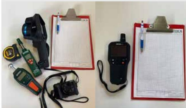
Ohne die MR277 von FLIR würden Sie normalerweise eine Wärmebildkamera, ein Feuchtigkeitsmessgerät ohne Nadel, ein Psychrometer und eine Fotokamera verwenden. Alle diese Funktionen sind jetzt in dem Gebäudeinspektions-System MR277 vereint.
