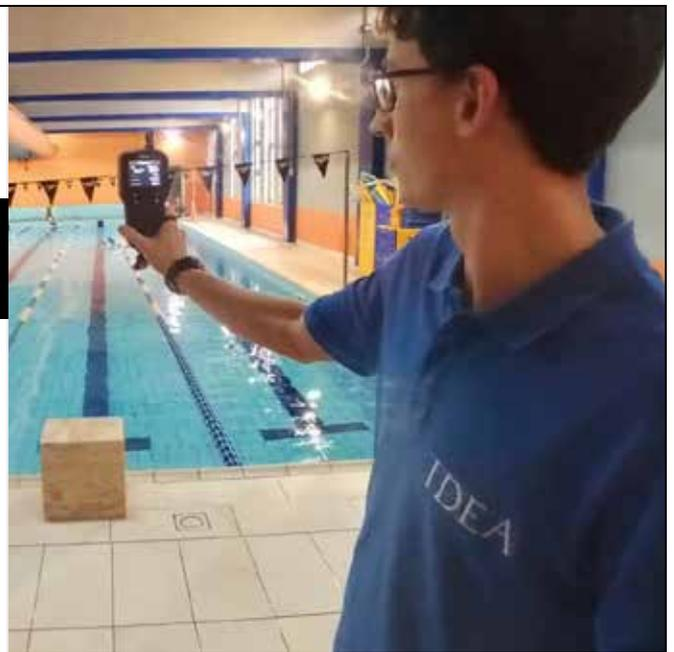
FLIR MR277 kombiniert die Vorteile der Wärmebildgebung mit der patentierten multispektralen dynamischen Bildgebung (MSX) von FLIR. Mit modernsten Umgebungssensoren, dank deren Hilfe die Fachleute Feuchtigkeitsprobleme schnell finden, klar identifizieren und einfach dokumentieren können.
