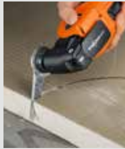
Zuschneiden von Bauplatten.
