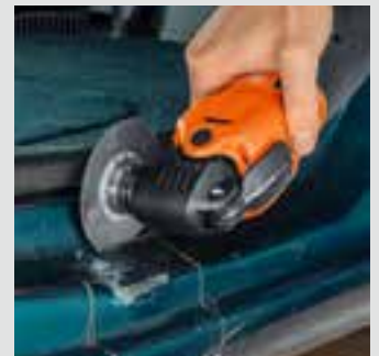
Verzugsfrei Sägen, saubere Schnittkanten, dünne Schnittlinie – bei Karosseriearbeiten ein Vorteil.
