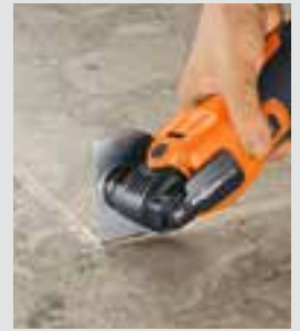
Diamant-Segmentmesser für Schnitte im Eckbereich.
