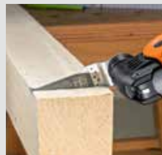
Auch starkes Konstruktionsholz lässt sich mit dem SUPERCUT problemlos ablängen.
