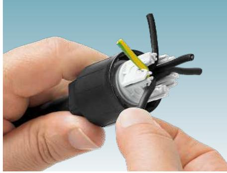
2. Adern in die QUICKON-Mutter einführen und in die gekennzeichneten (1, 2, 3...) Aderführungen einrasten.
