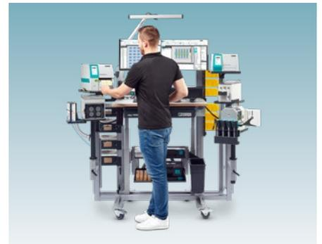
Das Werkerassistenzsystem clipx WIRE assist ermöglicht eine effiziente Leiterverarbeitung. Kombinieren Sie das softwaregestützte System mit Ihren Drucksystemen für eine einfache und ergonomische Leitervorbereitung.
