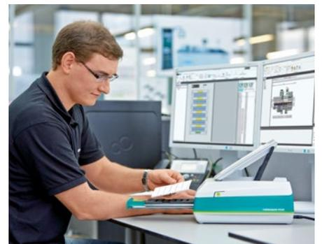
Im stationären Einsatz lässt sich der THERMOMARK PRIME unkompliziert über die MARKING system Software ansteuern und verwalten. Für die Kennzeichnung vor Ort verfügt der mobile Drucker über eine integrierte Software.
