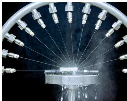
Die Bestimmung der IP-Schutzart von Kennzeichnungen erfolgt mithilfe eines Wasserdüsen-tests und drückt aus, welchen Schutzzumfang ein Material gegen das Eindringen von Fremdkörpern sowie der Dichtigkeit gegen Feuchtigkeit aufweist.
