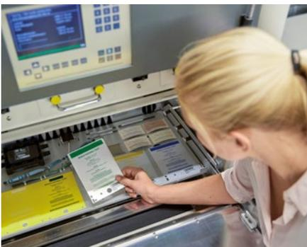
Um einen mehrjährigen Außeneinsatz zu simulieren, werden Markierungsmaterialien in unserem Labor zyklischen Beanspruchungen durch UV-Strahlung sowie Feuchtigkeit ausgesetzt und so nach der Norm DIN EN ISO 4892-2 geprüft.
