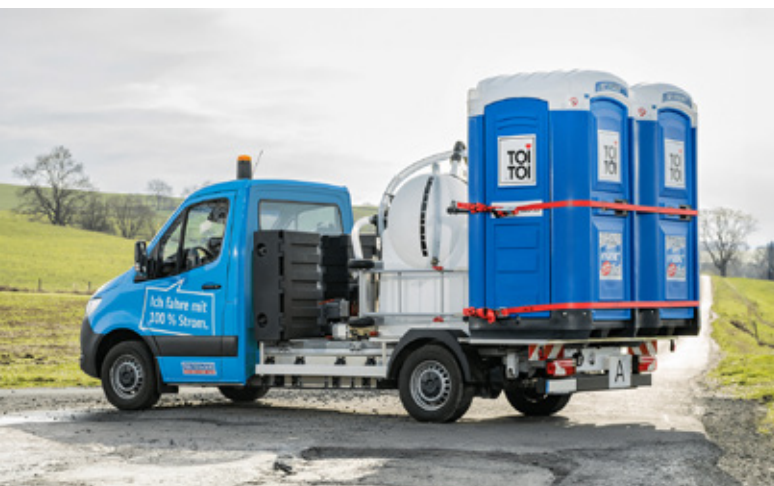
Elektrisches Servicefahrzeug für Toilettenkabinen Credit: Tobias Kromke, i.A. der TOI TOI & DIXI Fahrzeugtechnik GmbH
