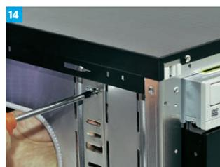
Befestigen Sie das Laufwerk im Gehäuse. Je nach Modell geschieht das mit Schrauben oder über Schienen.
