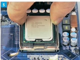
Beim Sockel 775 befinden sich die Pins nicht mehr am Prozessor, sondern im Steckplatz der Hauptplatine.
