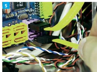
An einen freien S-ATA-Anschluss auf der Hauptplatine kommt das eine Ende des S-ATA-Kabels. Das andere...
