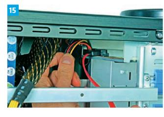
Aktuelle DVD-Brenner besitzen einen S-ATA-Anschluss. Schließen Sie S-ATA- und Stromkabel an das Laufwerk an. Falls Sie einen DVD-Brenner mit EIDE-Anschluss einsetzen, schließen Sie das Gerät wie eine EIDE-Festplatte an - fertig.
