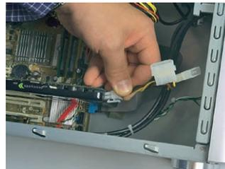
Entweder nutzen Sie einen Adapter oder ein Kabel vom Netzteil.
