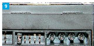
Sie können max. zwei Geräte über das Flachbandkabel anschließen. Wichtig ist, dass die Geräte entsprechend konfiguriert werden. In Einzelfällen kleine Brücken (Jumper)
