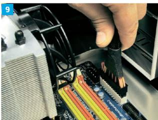
Die Hauptstromversorgung des Mainboards erfolgt über einen 20- und bei neueren Modellen mit 24-Pol-Stecker.
