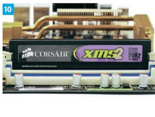
Unterstützt Ihr Mainboard „Dual-Channel“, dann sollten Sie zwei Bausteine gleicher Kapazität verwenden.
