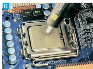
Für eine optimale Wärmeübertragung tragen Sie zwischen Kühlerboden und Prozessor Wärmeleitmittel (etwa Wärmeleitpaste) auf.
