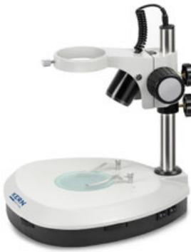
OZB-A5103 mit Grobtrieb sowie Auf- und Durchlicht
