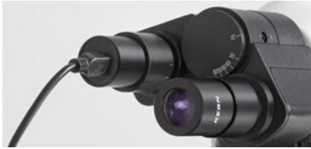
Okularkamera am Tubus befestigt
