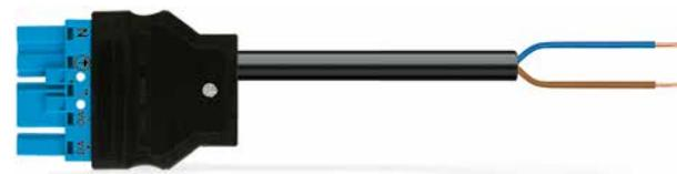
Adapterleitung ▶ Stecker – offenes Leitungsende ▶ Durchmesser der Mantelleitung: 6,8 ... 8,6 mm ▶ H05VV-F 2x1,5
