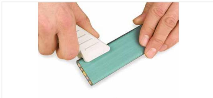
Flachleitungsmantel mit Abisoliermesser an beiden Seiten aufschneiden (Abmantellänge 30 mm!).
