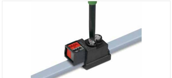
Flachleitung durch Anziehen der Schrauben kontaktieren. Anzugsdrehmoment von 1 Nm beachten!
