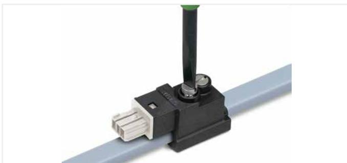
Flachleitung durch Anziehen der Schrauben kontaktieren. Anzugsdrehmoment von 1 Nm beachten!
