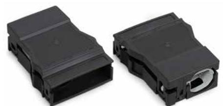
Zugentlastungsgehäuse; für 2 Leitungen; Leitungsdurchmesser 5 ... 9 mm; Abmantellänge 55 mm
