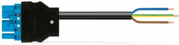
Adapterleitung ▶ Stecker – offenes Leitungsende ▶ Durchmesser der Mantelleitung: 7,4 ... 9,4 mm ▶ H05VV-F 3G1,5
