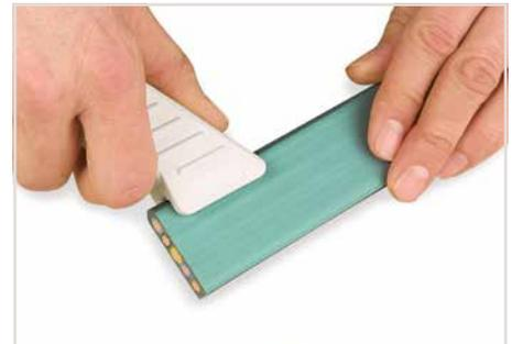
Flachleitungsmantel mit Abisoliermesser an beiden Seiten aufschneiden.
