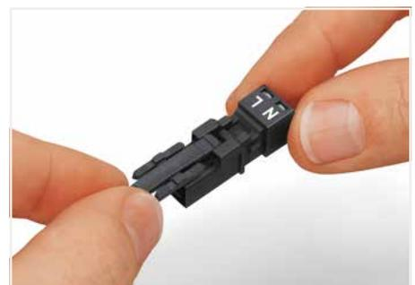
Verriegelungsklinken sind an allen fest zu installierenden Produkten (Snap-In-Varianten, Steckverbinder für Leiterplatten, Verteiler) werkseitig montiert, sodass immer eine Verriegelung mit den zu steckenden Buchsen bzw. Steckern stattfindet. Eine zusätzliche Verriegelungsklinke ist nur bei einer „fliegenden Verbindung“ (Buchse/Stecker) erforderlich.
