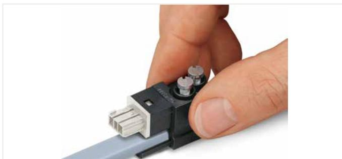
Das Aufschieben des IDC-Moduls ist nur möglich, wenn die Kodierung übereinstimmt. Blockiert die Kodierung des IDC-Moduls zum Unterteil, dann Modul um 180° drehen und aufschieben, bis beide bündig abschließen.
