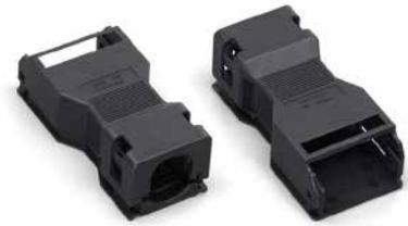
Zugentlastungsgehäuse; 3-polig; für Leitungsdurchmesser 4,5 ... 10 mm; Abmantellänge 40 mm
