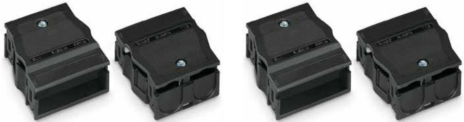
Zugentlastungsgehäuse; für 2 Leitungen; Leitungsdurchmesser 5 ... 9 mm; Abmantellänge 55 mm
