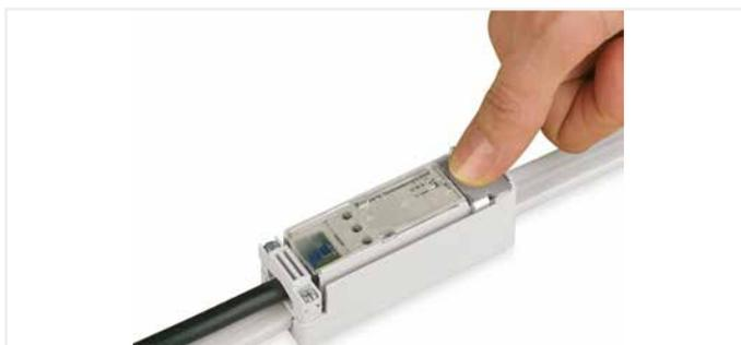
Oberteil auf Unterteil bis zum Anschlag einschieben und hörbar einrasten. Hebel herunterdrücken und verriegeln. Alle 3 Adern werden gleichzeitig kontaktiert.
