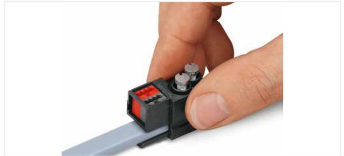
Das Aufschieben des IDC-Moduls ist nur möglich, wenn die Kodierung übereinstimmt. Blockiert die Kodierung des IDC-Moduls zum Unterteil, dann Modul um 180° drehen und aufschieben, bis beide bündig abschließen.
