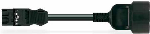
Verbindungsleitung ▶ Stecker – SCHUKO®-Kupplung ▶ 1,5 mm<sup>2</sup> ▶ Durchmesser der Mantelleitung: 7,4 ... 9,4 mm ▶ H05VV-F 3G1,5
