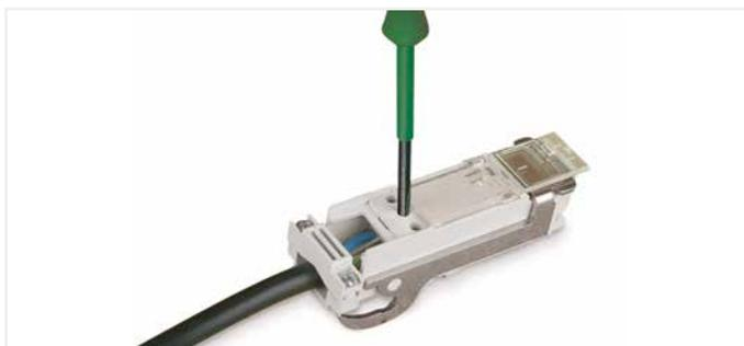
Abgangsleitung ablängen, abmanteln, abisolieren und einführen. Schrauben fest anziehen (Anzugsdrehmoment 0,7 Nm).
