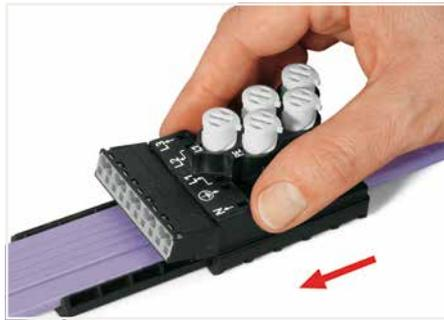
IDC-Modul bündig auf das Unterteil aufschieben. Ist dies durch die blockierende Kodierung nicht möglich, Oberteil um 180° gedreht aufschieben.
