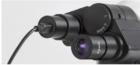
Okularkamera am Tubus befestigt
