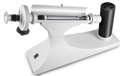
Küvette in Messkammer
