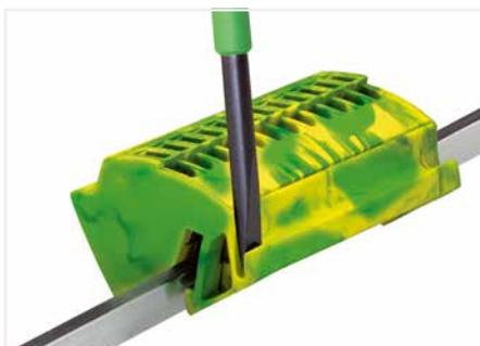
PE-Anschlussblock durch Entriegeln der linken und rechten Blockseite demontieren. Block dann nach oben von der Sammelschiene ziehen.
