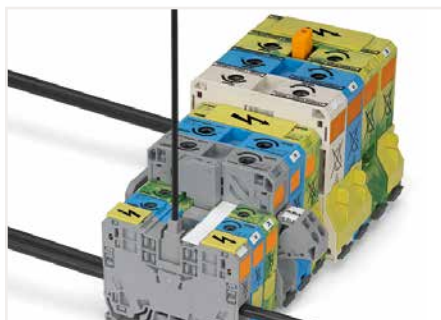
Potentialabgriff (283-407) in der Reihenklemme immer bis zum Anschlag hinunterdrücken!
