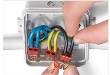
Lösen: Leiter festhalten, Klemme durch Hin- und Herdrehen mit leichtem Zug vom Leiter ziehen.
