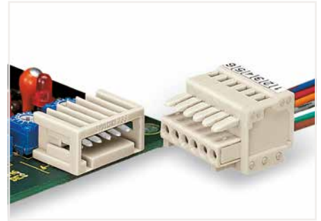
Stift- und Federleisten – 100 % fehlsteckgeschützt Nur polzahlgleiche Stift- und Federleisten können miteinander gesteckt werden.
