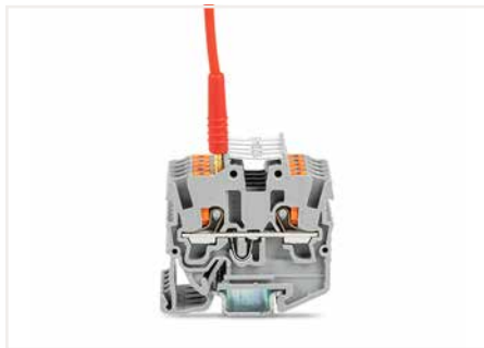
Prüfen mit einem Prüfstecker (210-136) (Durchmesser 2 mm), max. 42 V
