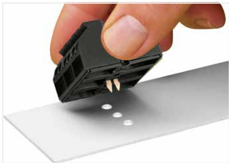
Direktkontaktierung des PE-Kontaktes zur Montageplatte Automatisches Durchstoßen einer eventuell vorhandenen Lackschicht
