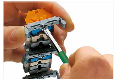
Klemmenleiste mit Befestigungsflanschen, Anschrauben des Montagefußes 209-123 (Der Abstand der Montagefüße zueinander unter einer Klemmenleiste soll ca. 35 ... 40 mm betragen.)
