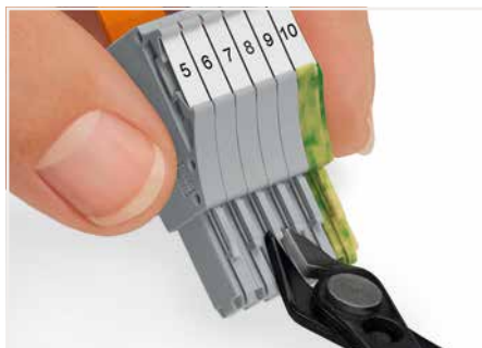
Federleiste kodieren, gewünschte Kodiernahe mittels geeignetem Werkzeug von der Federleiste abtrennen.
