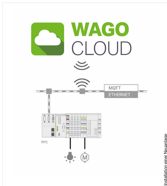
Retrofit – parallele Installation zu bestehenden Anlagen
