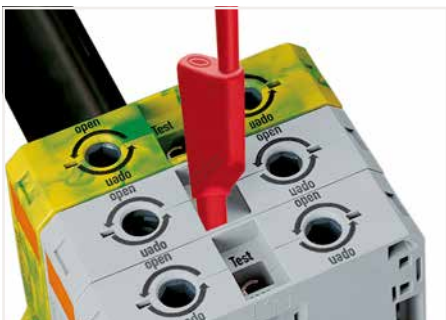
Prüfen mit berührungsgeschütztem Prüfstecker Ø 4 mm Bei der 35mm 2 -Klemme wird ein Prüfstecker mit Prüfadapter (283-404) verwendet (Prüfstecker sind nicht im WAGO Lieferprogramm enthalten – z. B. Fa. Multi-Contact Deutschland GmbH).
