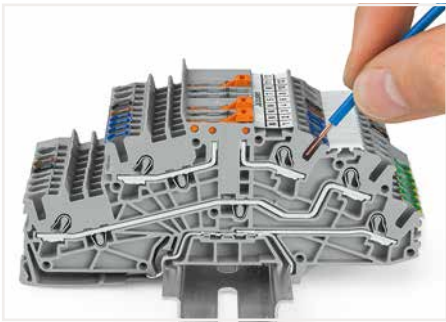
Leiter anschließen – direkt stecken. Eindrängige Leiter lassen sich bis zu einem Querschnitt über und mindestens zwei Querschnittstufen unter dem Nennquerschnitt direkt stecken, ohne Werkzeug.
