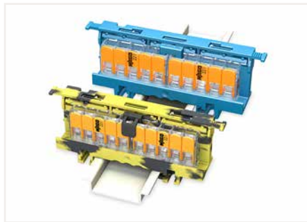
Aufbau von Potentialverteilungen mit bis zu 8 Klemmstellen im Tragschienenadapter, wahlweise mit Verriegelung gegen unbeabsichtigtes Auftrennen der Verbindung (Zuhaltefunktion)
