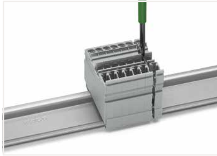
Verband mit Betätigungswerkzeug (Klinge 3,5 x 0,5 mm) öffnen.
