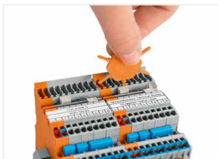
Kodierstift in gewünschte Kodieröffnung der Klemme einführen und abdrehen.
