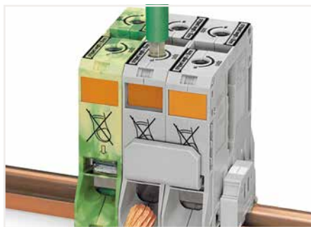
Leiteranschluss bei 50, 95 und 185 mm 2 – Schritt 2 Abisolierten Leiter bis zum Anschlag in die Klemmstelle führen und in dieser Position halten.
