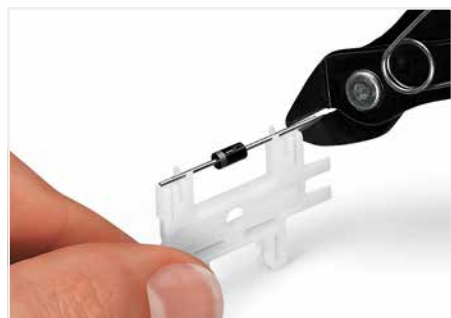
Bauelement auf richtige Länge bringen.
