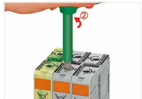
Leiteranschluss bei 50, 95 und 185 mm 2 – Schritt 3 Durch weiteren kurzen Linksdreh ② wird die Sperre aufgehoben und der Innensechskantschlüssel ohne Kraft zurückgeführt. Der Leiter ist sicher geklemmt.
