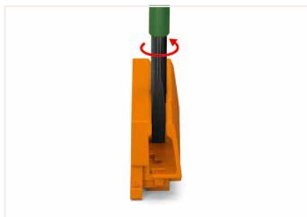
Verrastung mit Betätigungswerkzeug (Klinge 5,5 mm) entriegeln und Klemmschlitten durch Drehen des Werkzeuges auf gewünschte Breite bringen.
