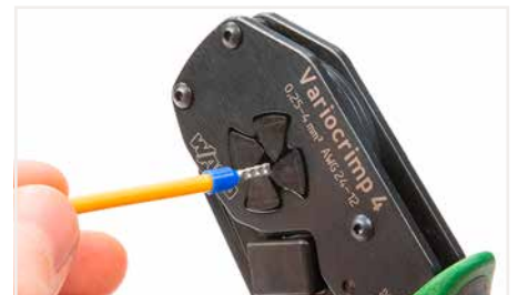
Leiter mit aufgesteckter Aderendhülse in die Crimp-Station einführen.
