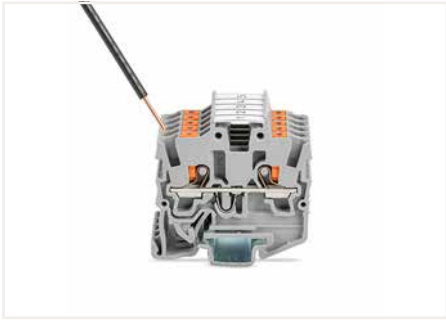
Direktes Stecken (Push-in) – eindrängige Leiter oder feindrängige Leiter mit Aderendhülse.
