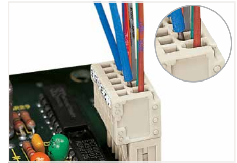
Prüfen mit Prüfstift (Ø 1 mm, Bestellnr. 735-500), Tippkontakt
