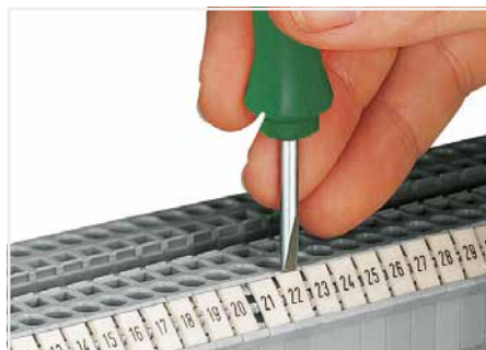
Einrasten eines WMB-Beschriftungsstreifens in die Beschriftungsaufnahme
