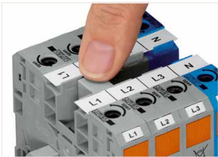
Brücken bei 35 mm 2 : Brücken benachbarter Klemmen mit Querbrückern in der Klemmenmitte Zum Lösen Betätigungswerkzeug verwenden.
