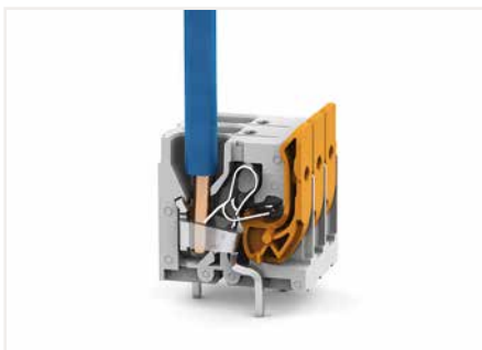
Eindrängige Leiter direkt steckbar, feindrängige Leiter nur bei geöffnetem Hebel anschließbar – Serie 2606
