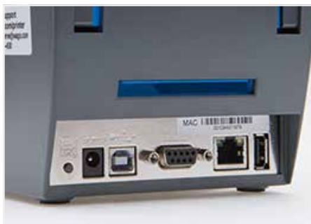
Drucker verfügt über mehrere Schnittstellen: USB, ETHERNET, serieller COM-Port
