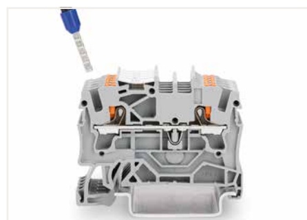
Direktes Stecken (Push-in) – eindrängige Leiter und Leiter mit Aderendhülse
