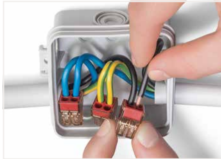
Anschließen: Abisolierten eindrähtigen Leiter bis zum Anschlag hineinstecken.
