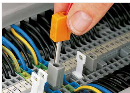
Prüfen mit Bananenstecker Hier über den Prüfadapter (209-170)
