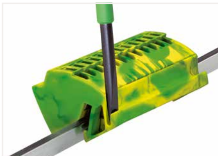
Demontage des PE-Anschlussblocks durch Entriegeln der linken und rechten Blockseite; Block dann nach oben von der Sammelschiene ziehen.
