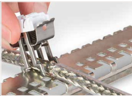
Schirmklemmbügel auf der spezialgelochten Tragschiene (790-145) aufsetzen. Finger nicht unter den Bügel legen und dann die Feder entspannen!
