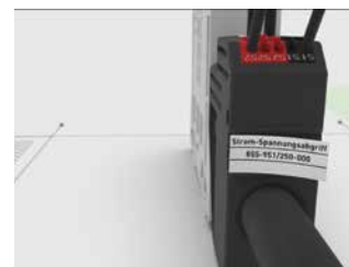
Beschriftung mit Beschriftungsstreifen
