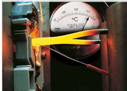
Glühdrahtprüfung gemäß IEC/EN 60998-1, IEC/EN 60695-2-11
