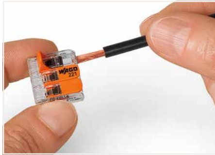
Leiter anschließen: Klemmstelle durch Hebel öffnen und Leiter einführen.
