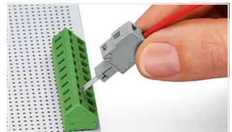
Leiter mit aufgesteckter Aderendhülse in die Crimp-Station einführen.
