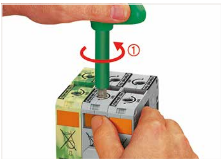
Leiteranschluss bei 50, 95 und 185 mm 2 – Schritt 1 Innensechskantschlüssel gegen den Uhrzeigersinn bis zum Anschlag drehen ①, dann orangefarbene Taste (Arretierungsfunktion) drücken, Anschlussstelle bleibt geöffnet.
