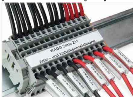
Einsteckschild in die Aufnahme einer Kennzeichnungstülle schieben. Änderungen der Beschriftung sind auch bei abgeschlossenem Leiter noch nachträglich möglich.
