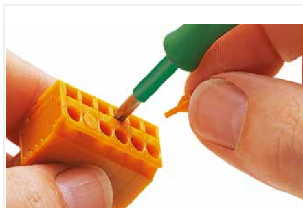
Verschließen nicht benötigter Klemmstellen an Stift- und Federleisten mit CAGE CLAMP®-Anschluss, zum Beispiel zur Verdopplung des Rastermaßes, wenn die Luft- und Kriechstreckenanforderungen einer Applikation dieses erforderlich machen und die Bemessungsspannung des Artikels erhöht werden muss; die Verschlussstifte sind nicht an abgewinkelten Federleisten für Oberflächenmontage einsetzbar.
