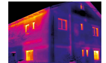
Energieverluste von Gebäuden aufspüren: Wärmebrücken an Fassaden oder im Gebäude sofort erkennen und abbilden.
