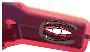
Megger-Klemme wird mit dem genormten Prüffinger gemäß IEC-Norm auf Kriech- und Luftstrecken geprüft.
