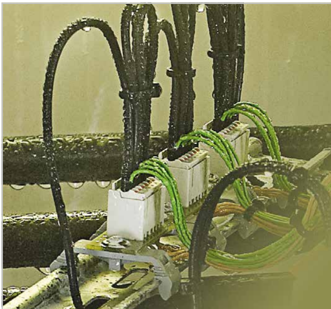
Salznebelkammer mit picoMAX ® -Prüfaufbau.
