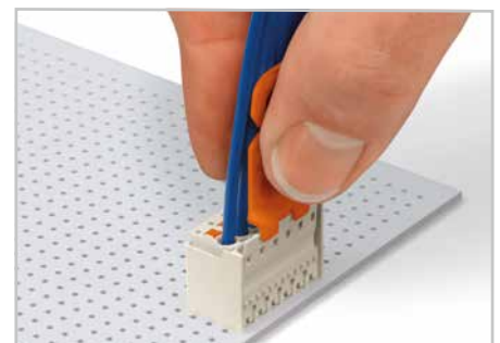
Entriegelungswerkzeug bis zum Anschlag einführen. Der Keil am Entriegelungswerkzeug öffnet die Rastlasche, und die Verriegelung wird freigegeben.
