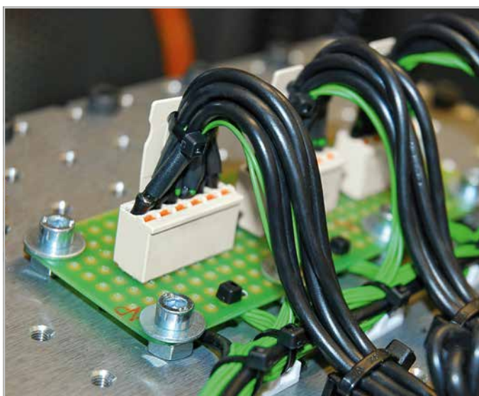
Vibrationsprüfung einer „Wire-to-Board“-Verbindung, picoMAX® eCOM , Serie 2091
