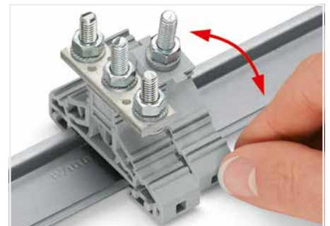
Klemmensseite mit Federelement in Richtung Schienenmitte drücken und auf- bzw. abschwenken.
