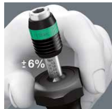
Messgenauigkeit \pm 6\% (Artikel 1430: \pm 10\% ) nach Norm DIN EN ISO 6789. Deutlich hör- und spürbares Überrassten beim Erreichen des eingestellten Drehmoments.
