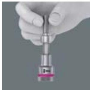
Die Klemmung der Innensechskant-Schraube auf der Bit-Nuss wird durch eine federnde Kugel auf der Bitspitze gewährleistet. Besonders hilfreich in schwer zugänglichen Arbeitsbereichen, wo man die zweite Hand nicht zum Festhalten der Schraube nutzen kann.
