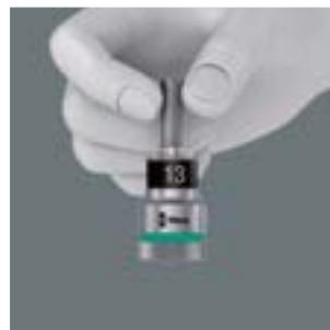
Die Klemmung der Außen-sechskant-Schraube, bzw. der Mutter im Steckschlüsseleinsatz wird durch zwei dauernde Kugeln und einen dauerelastischen hochfesten Schrumpfschlauch gewährleistet. Dieser wird durch einen vorderen Stahlbund wirksam gegen mechanische Verletzungen geschützt. Besonders hilfreich in schwer zugänglichen Arbeitsbereichen, wo man die zweite Hand nicht zum Festhalten der Schraube nutzen kann.
