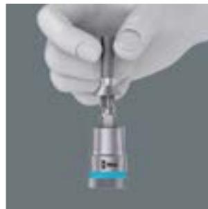
Die von Wera entwickelten TORX® HF Werkzeuge zeichnen sich durch eine geometrische Optimierung des ursprünglichen TORX®-Profils aus. Durch die aus der Flächenpressung zwischen der Abtriebspitze und Schraubenprofil resultierende Klemmkraft werden TORX®-Schrauben
