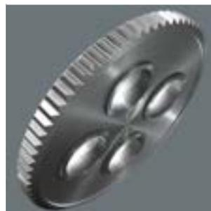
Die mit 72 Zähnen feinverzahnte Umschaltnarre hat einen niedrigen Rückholwinkel von nur 5°. Der kleine Hub ermöglicht schnelles und präzises Arbeiten in allen Einbaulagen.
