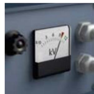
Die Prüfung des Werkzeugs auf Durchschlagsfestigkeit bei 10.000 Volt gibt dem Anwender die beruhigende Gewissheit, dass sein Schraubendreher auf seine wichtigste Eigenschaft, die Isolation, geprüft worden ist. Wera VDE-Schraubendreher werden Stück für Stück dieser Prüfung unterzogen.
