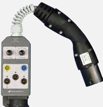
**1- und 3-phasiger Prüfadapter mit Stecker Typ 2 zum Prüfen der Wirksamkeit von Schutzmaßnahmen an E-Ladestationen mit dem PROFITEST MTECH+ / MXTRA, Simulation von fiktiv angeschlossenen Elektrofahrzeugen sowie Simulation der Strombelastbarkeit von Ladegarnituren gemäß IEC 61851-1**
