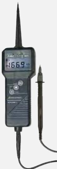
Digitales Niederohmmessgerät für Messungen von Schutzleitern und Potenzialausgleichsleitern u.v.m. nach VDE 0413-4 / DIN EN 61557-4
