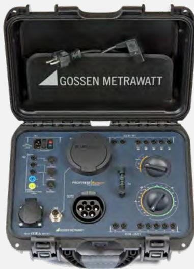
Der PROFITEST E-Mobility ist ein Adapter zur normgerechten Prüfung von 1- und 3-phasigen Ladekabeln Mode 2 und 3 durch Simulation von Fehlerfällen nach DIN VDE 0701-0702 sowie Herstellerangaben. Der PROFITEST E-Mobility macht Ihnen die Investitionsentscheidung leicht. Denn mit dem perfekt auf die Anforderungen zugeschnittene Zubehör können 1- und 3-phasige Ladekabel Mode 2 und 3 nach DIN VDE 0701-0702 sowie Herstellerangaben schnell und sicher normkonform geprüft werden.
