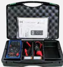
4 $\frac{3}{4}$ -stelliges Milliohmometer für Ex-gefährdeten Bereichen zur Messung von niederohmigen Übergängen in explosionsgefährdeten Bereichen z. B. Kontakte innerhalb des Flugzeugtanks (Bonding-Test) sowie für allgemeine Niederohm-Messungen innerhalb oder außerhalb des Ex-Bereichs z. B. an der Flugzeugaußenhaut – Blitzschutz, „Ableitertest“ (Wick-Test)
