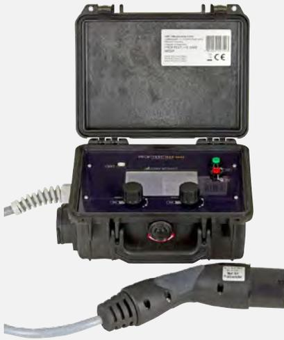
Das Prüfgerät ist für die Überprüfung des Funktionsverhaltens von Ladesäulen für Elektrofahrzeuge mit Anschlussbuchse Typ 2 (Mode 3 Laden) bestimmt.
