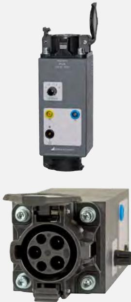
**1-phasiger Prüfadapter mit Stecker Typ 1 zum Prüfen der Wirksamkeit von Schutzmaßnahmen an E-Ladestationen mit dem PROFITEST MTECH+ / MXTRA, Simulation von fiktiv angeschlossenen Elektrofahrzeugen sowie Simulation der Strombelastbarkeit von Ladegarnituren gemäß IEC 61851-1**
