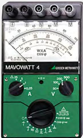
Das Vielfach-Leistungsmessgerät für direkte Leistungsmessungen bei Gleichstrom sowie Wirkleistungsmessungen bei Einphasen-Wechselstrom und gleich belastetem Dreileiter-Drehstrom.
