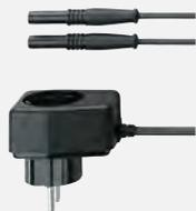
Zur sicheren und problemlosen Messung der Stromaufnahme (max. 16 A) über Schuko-Netzstecker angeschlossener Verbraucher. Das Kabel mit berührungsgeschützten Anschlüssen wird an den Strommessbuchsen des Multimeters angeschlossen.
