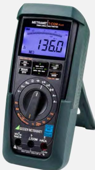
**$3\frac{3}{4}$ -stelliges Kabelmultimeter für symmetrische Kupferkabel in Telekommunikationsnetzen. Systemgerät mit Datenspeicher, IR-Schnittstelle und 25 Multimeterfunktionen**
