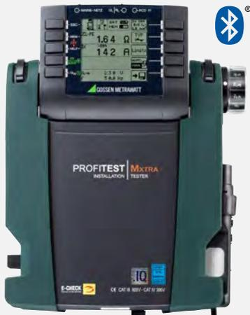
Zur Prüfung der Wirksamkeit von Schutzmaßnahmen in elektrischen Anlagen entsprechend DIN VDE 0100–600/VDE 0105–100 für den Einsatz in allen Wechselstrom- und Drehstromnetzen mit Spannungen von 65 bis 500V und Frequenzen von 15,4 bis 420 Hz. Niederohm-, Isolations-, Erdwiderstands-, Standortisolation-, Schleifen- und Netzimpedanzmessung, Prüfen von Fehlerschutzeinrichtungen RCD's, RCM's, IMD's, PRCD's, E-Ladesäulen.
