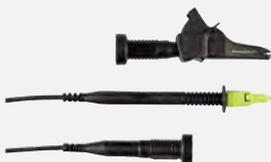
Kabelset **KS24** bestehend aus einem 4 m langen Verlängerungskabel mit fest angeschlossener Prüfspitze und einer berührungsgeschützten Buchse am anderen Ende; aufsteckbarer Krokodilclip.
