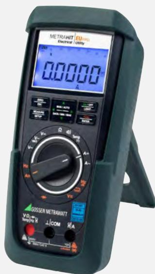
Spezialmultimeter für den Anschluss an Stromwandler ohne Schmelzsicherung, um eine Gefährdung durch die Unterbrechung der Wandlerkreise zu verhindern (deshalb Messkategorie 600 V CAT II)
