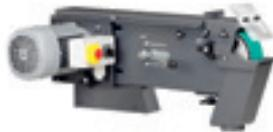
Hochleistungsbandschleifer, modular ausbaufähig, für Industrie- und Serienanwendungen, ideal für die Edelstahlbearbeitung.
