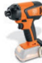
Akku-Schlagschrauber mit bürstenlosem Motor und Drehmomenteinstellung in 6 Stufen. Für universelle Verschraubungen inkl. Selbstbohrschrauben.
