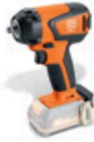
Akku-Schlagschrauber mit bürstenlosem Motor und Drehmomenteinstellung in 6 Stufen. Für metrische Verschraubungen bis M14.
