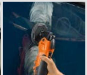
Entfernen von Kratzern in Fahrzeuglacken mit dem Filzpolierpad und Poliermittel.
