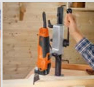
Stationärer Einsatz im Bohrstand.
