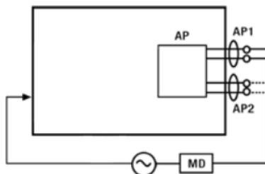
Messkreis für die Messung des ABLEITSTROMES VOM ANWENDUNGSTEIL
