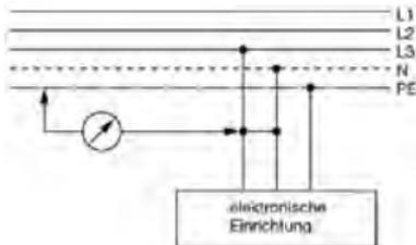
bei Stromkreisen mit elektronischen Einrichtungen
