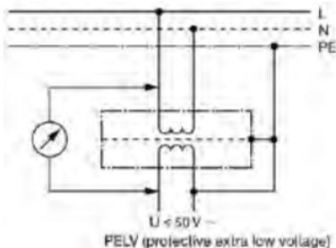
bei Funktionskleinspannung (PELV), durch Sicherheitstransformator nach DIN VDE 0551 erzeugt
