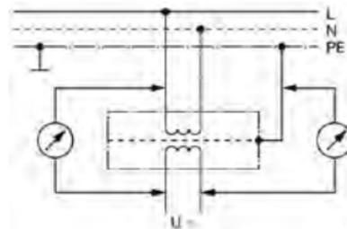
bei Schutztrennung durch Trenntransformator nach DIN VDE 0551
