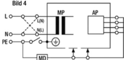
Messkreis für die Messung des GERÄTEABLEITSTROMES – Direktmessung
