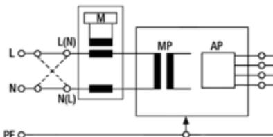
**ANMERKUNG 1:** Bei ME GERÄTEN der SCHUTZKLASSE I kann es erforderlich sein, die Ableitströme von den BERÜHRBAREN LEITFÄHIGEN TEILEN, die nicht an den Schutzleiter angeschlossen sind, getrennt zu messen.
