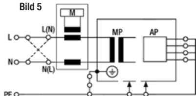
Messkreis für die Messung des GERÄTEABLEITSTROMES – Differenzmessung
