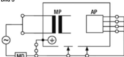
Messkreis für die Messung des GERÄTEABLEITSTROMES – Ersatzmessung
