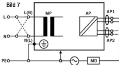
Messkreis für die Messung des ABLEITSTROMES VOM ANWENDUNGSTEIL –
