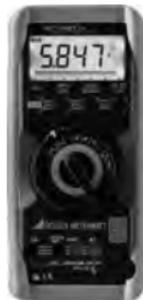
**METRAHIT | WORLD** **$3\frac{6}{7}$  - stelliges Universal TRMS-Digital-Multimeter mit Analogskala für den Einsatz in allen Bereichen der Elektrotechnik, insbesondere im internationalen Umfeld**
