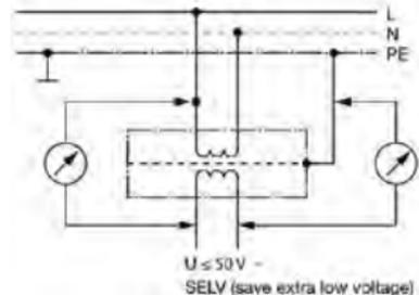
bei Schutzkleinspannung (SELV) durch Sicherheitstransformator nach DIN VDE 0551 erzeugt
