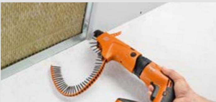
**Bis zu 6-mal schneller schrauben mit Magazinvorsatz**
