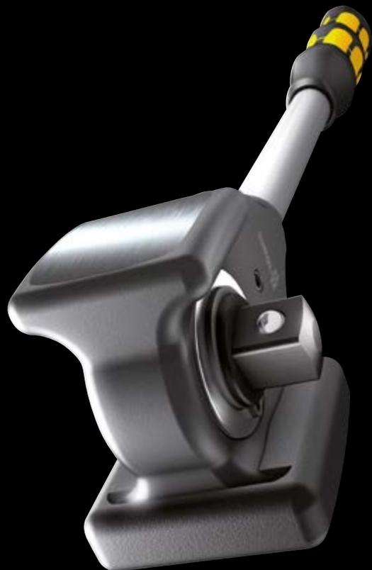
Mit Doppelklinkenverzahnung. Gibt den robusten 30 Sägezähnen den feinmechanischen Effekt einer 60er Feinverzahnung mit 6° Rückholwinkel.
