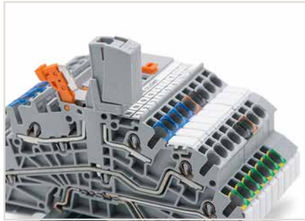
Bei Installationsetagenklempen mit interner N-Trennung können bei getrenntem N-Potential Prüfadapter in den freigewordenen Vertikalprüfschacht eingesetzt werden.
