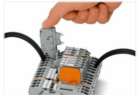
Sicherungsklemme mit schwenkbarem Sicherungshalter Sicherungshalter in Endposition ausschwenken.
