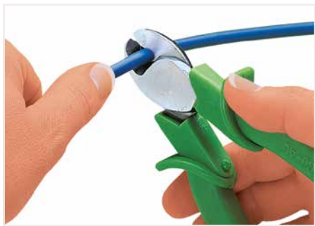
Abschneiden der Leitung
