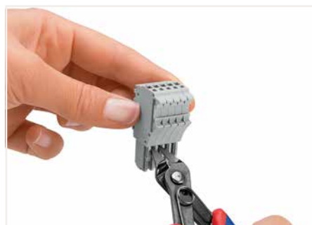
Kodiernase mittels Schneidwerkzeug entfernen.
