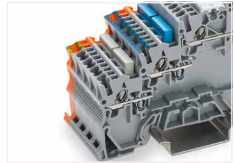
Brücken von PE Bei Initiatoren-/Aktorenklemmen ohne PE-Kontakterung zur Tragschiene kann die PE-Verbindung über die Brücke zur Klemme mit PE-Fuß erfolgen.
