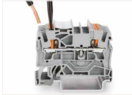
Leiter anschließen mit Betätigungswerkzeug – feindrätige Leiter
