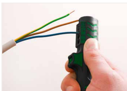
Abisolierung der Leiterisolierung
