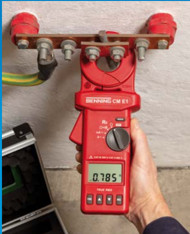
Erdungswiderstand eines Anlagenerders
