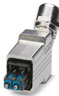
SC-RJ-Steckverbinder, Kabelabgang nach oben, für Polymerfaser 980/1000 µm
